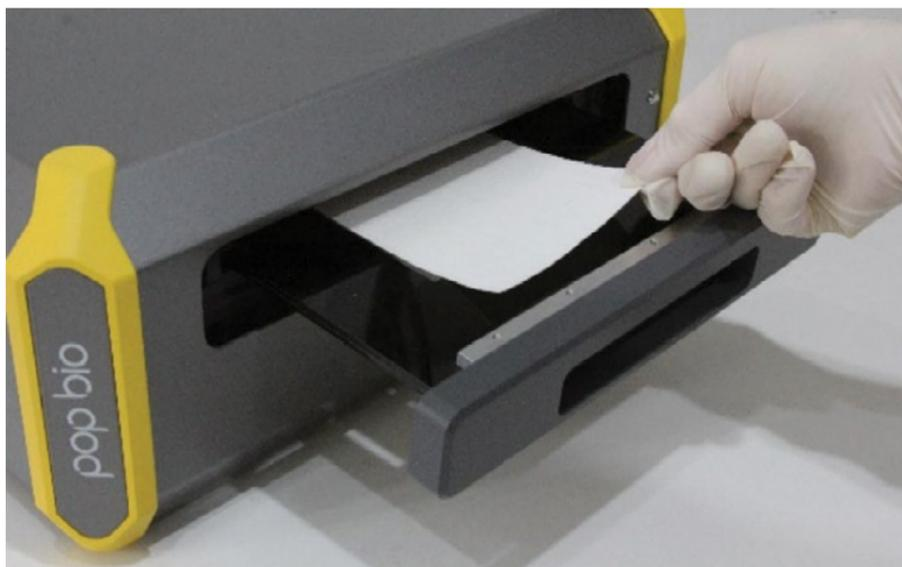
Гель-документирующая система Vi от компании Pop-Bio Imaging – это не обычная система визуализации гель-электрофореза. Система Pop-Bio Imaging не имеет камеры, объективов, фильтров или лазеров. Вместо этого используется абсолютно новая разработанная технология со сверхвысокой чувствительностью и разрешением.
