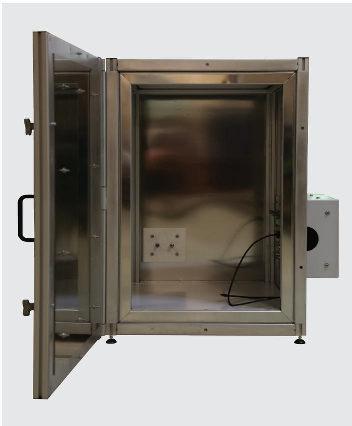
7 Камера для экранирования постоянного магнитного поля земли
