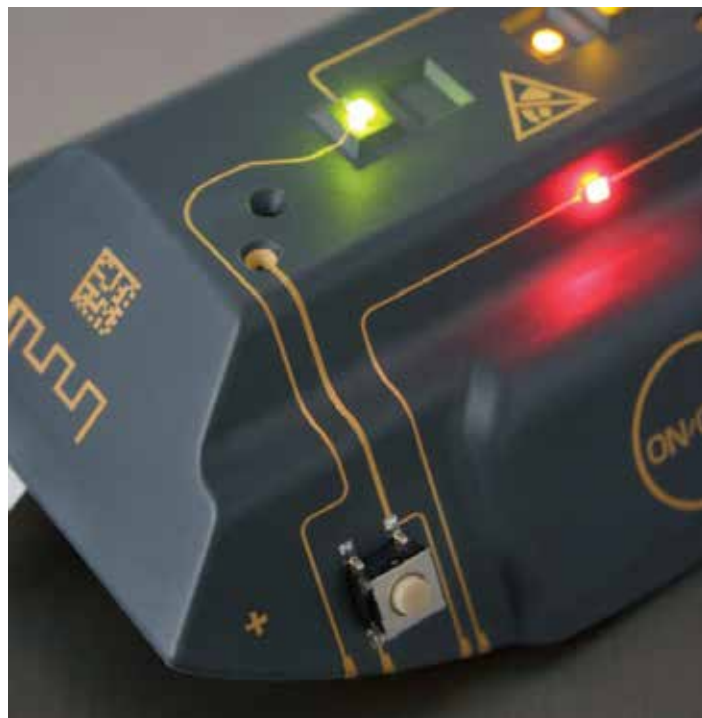
8 Технология позволяет монтировать компоненты на разные поверхности трехмерного изделия
