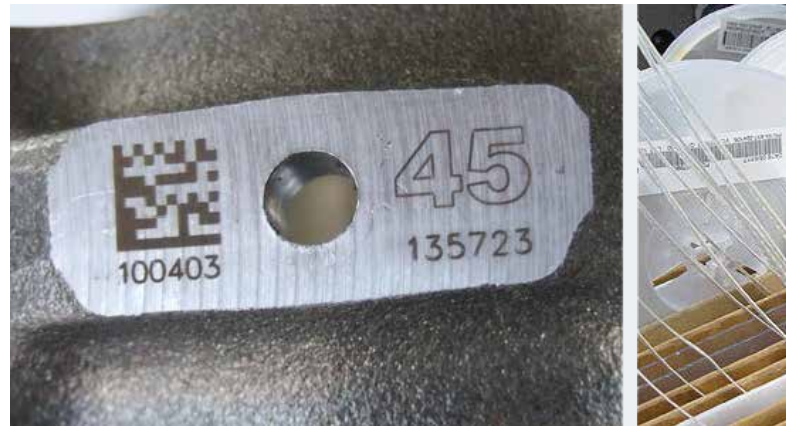
4 Способы идентификации: прямая маркировка, наклеиваемые этикетки, радиочастотные метки
