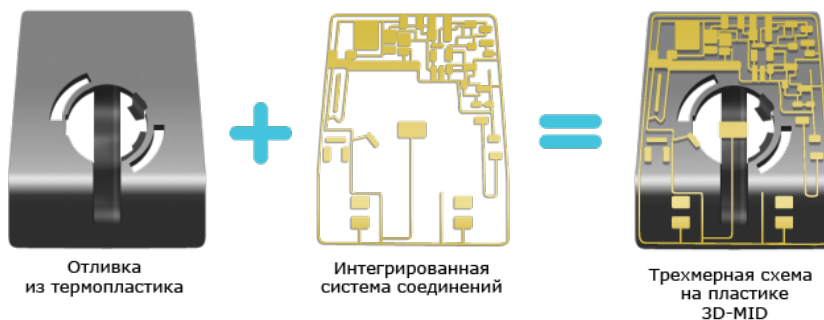
1 Трехмерные схемы на пластике – объединение пластикового основания, интегрированной системы поверхностных межсоединений и установленных электронных компонентов
