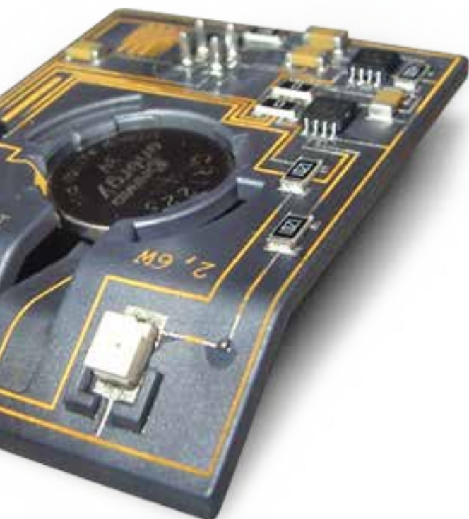
1 Трехмерные схемы на пластике – объединение пластикового основания, интегрированной системы поверхностных межсоединений и установленных электронных компонентов
