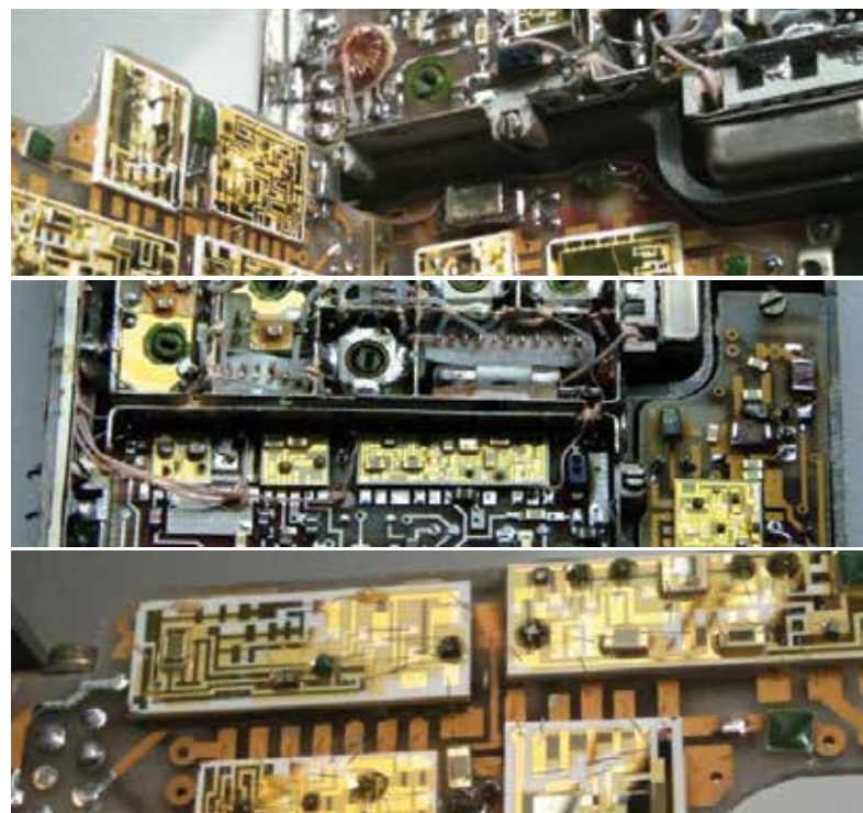
2 Типовые примеры модулей и блоков, выполненных с применением традиционной тонкопленочной технологии производства ГИС
