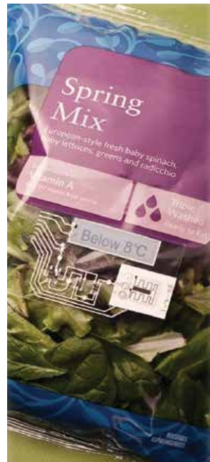
7 Прототип «умной» упаковки, отслеживающей температуру скоропортящегося товара во время транспортировки и хранения. Источник: Thinfilm
