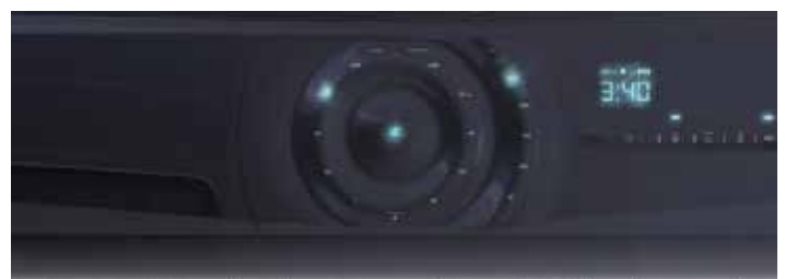
4 Дизайнерский эскиз панели управления стиральной машины (а) и действующее изделие (б), изготовленное по технологии 3D-MID. Изделие получается полностью герметичным и основано на сенсорном управлении
