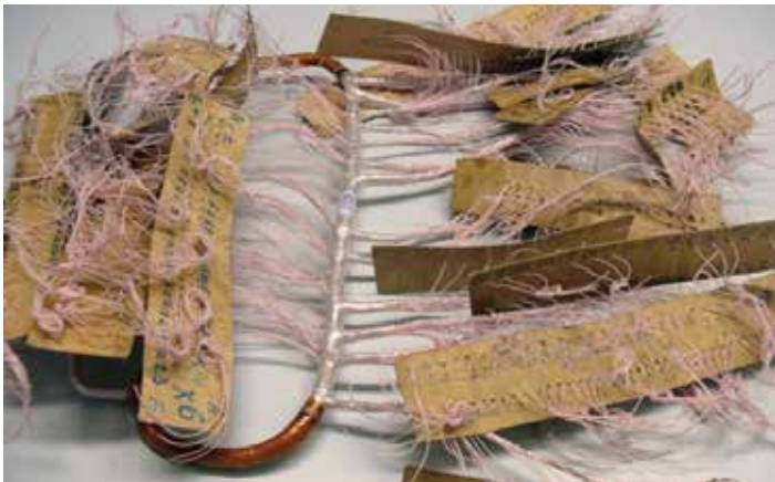
1 Жгут с идентификацией проводов на картонной бирке
