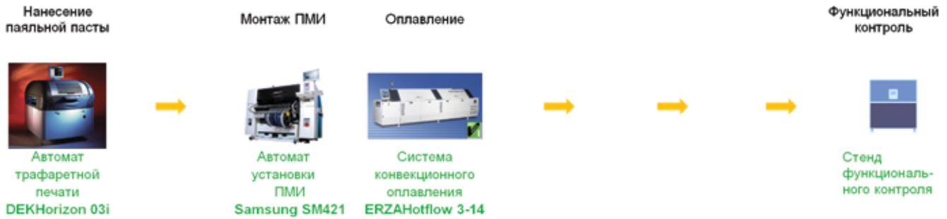
Рис. 11 Схема технологического процесса сборки печатных узлов без систем контроля и инспекции
