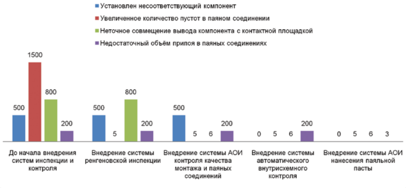
Рис. 13 Снижение уровня дефектности выпускаемой продукции при последовательном внедрении автоматических систем инспекции и контроля
