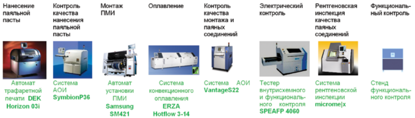
Рис. 14 Схема технологического процесса сборки печатных узлов при внедрении современных автоматических систем инспекции и контроля
