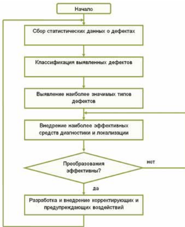
Рис. 12 Алгоритм процесса достижения запланированного уровня качества выпускаемой продукции
