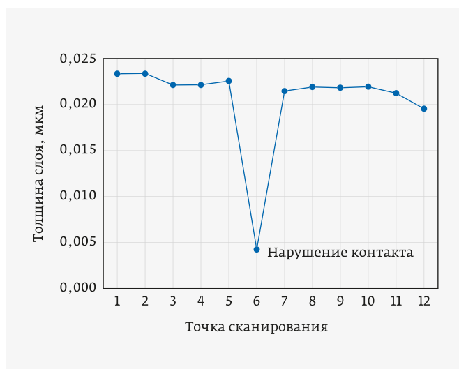
Рис. 8. Зависимость толщины слоя Au от точки сканирования. Сканирование проведено по линии с шагом 0,5 мм, диаметр пятна фокусировки (поликапиллярная оптика) 0,6 мм
