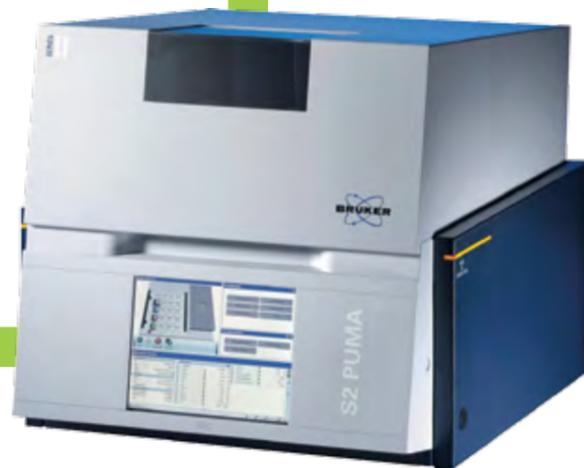
**Спектрометр S2 PUMA предназначен для анализа элементов от углерода до америция в диапазоне концентраций от ppm до 100% в жидких, твердых и порошковых пробах.**
