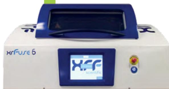
XrFuse 6 – электрическая печь на 6 позиций для приготовления сплавленных дисков для рентгенофлуоресцентного анализа или растворов для ICP.
