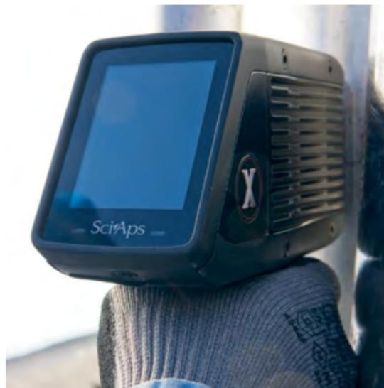
При весе 1,3кг X-550 и X-505 являются самыми легкими анализаторами из когда-либо созданных, в основном в металлическом корпусе, обеспечивающем максимальную надежность и рабочий цикл. Узкий и тонкий форм-фактор обеспечивает доступ к самым сложным местам проведения испытаний, с новейшим 2,7-дюймовым (68,6 мм) дисплеем для просмотра оценок и химического состава сзади.
