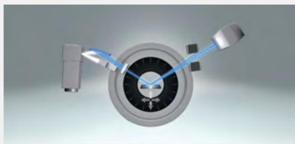
D8 ADVANCE с DAVINCI.DESIGN олицетворяет новейший концепт дифрактометров, который исключает трудоемкую регулировку и позволяет настроить прибор раз и навсегда. Теперь очень просто менять компоненты и геометрии прибора. D8 ADVANCE с DAVINCI.DESIGN является уникальной модульной системой, включающей все оптические компоненты.
