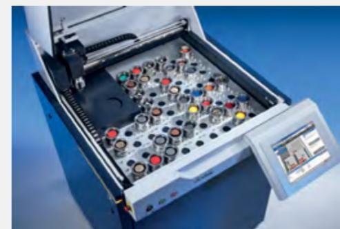
Технология SampleCare защищает все важные компоненты системы от загрязнения, которое может приводить к получению неверных результатов, а в худшем случае - вывести прибор из строя. В спектрометре S8 TIGER с технологией SampleCare установлены следующие элементы: экран из упрочненного бериллия и колесо с фильтрами защищают окно рентгеновской трубки; устройство смены масок и вакуум-затвор защищают камеру гониометра.
