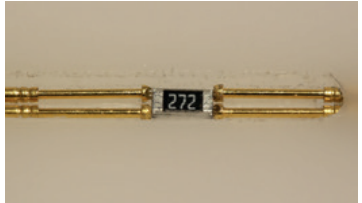
8 Принцип контактирования в адаптере. Верхние запирающие крышки сняты
