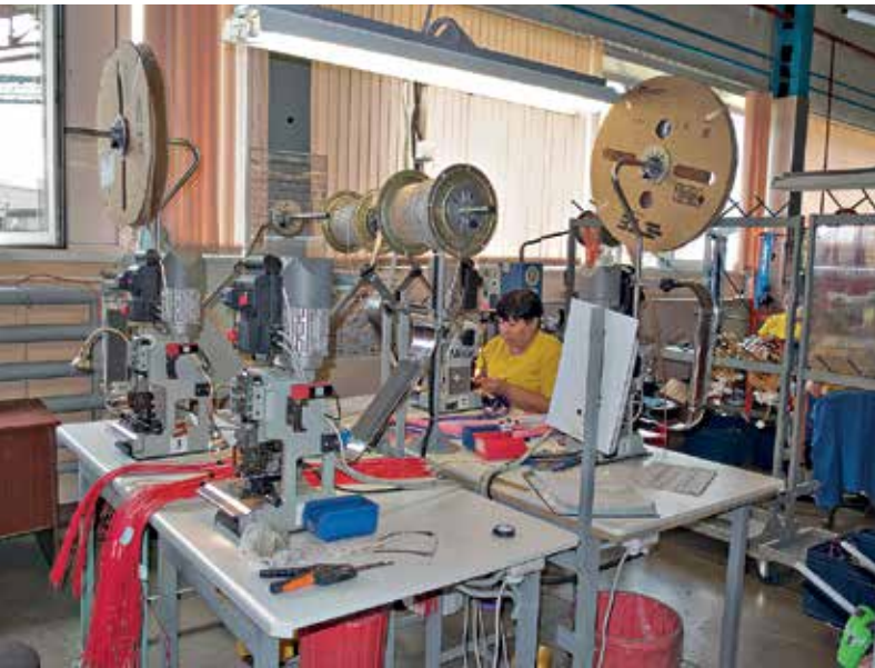
Участок полуавтоматической опрессовки, оснащенный прессами Mecal; установка ультразвуковой сварки
