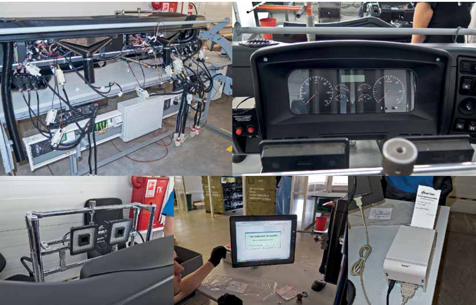
Собранная панель на проверочном стенде. Внизу: видеокamеры фиксируют работу всех индикаторов панели. Если тест успешно пройден, автоматически распечатывается чек
