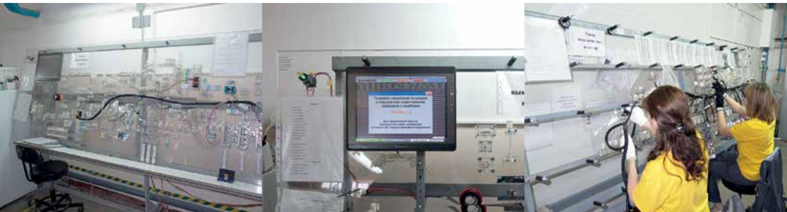
Диагностический стенд; сообщение об ошибке; подключение жгута к стенду
