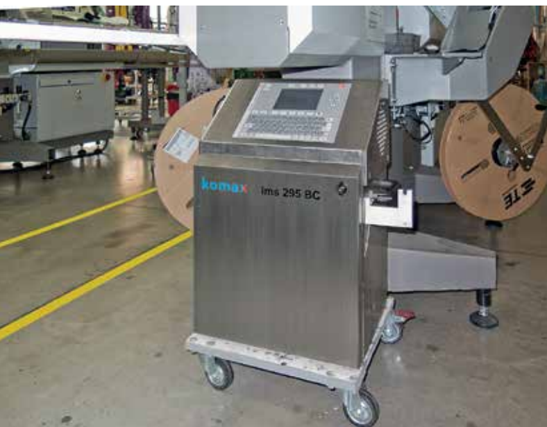
Струйный принтер ims 295 BC для маркировки проводов в составе линии Alpha 355; маркированные провода
