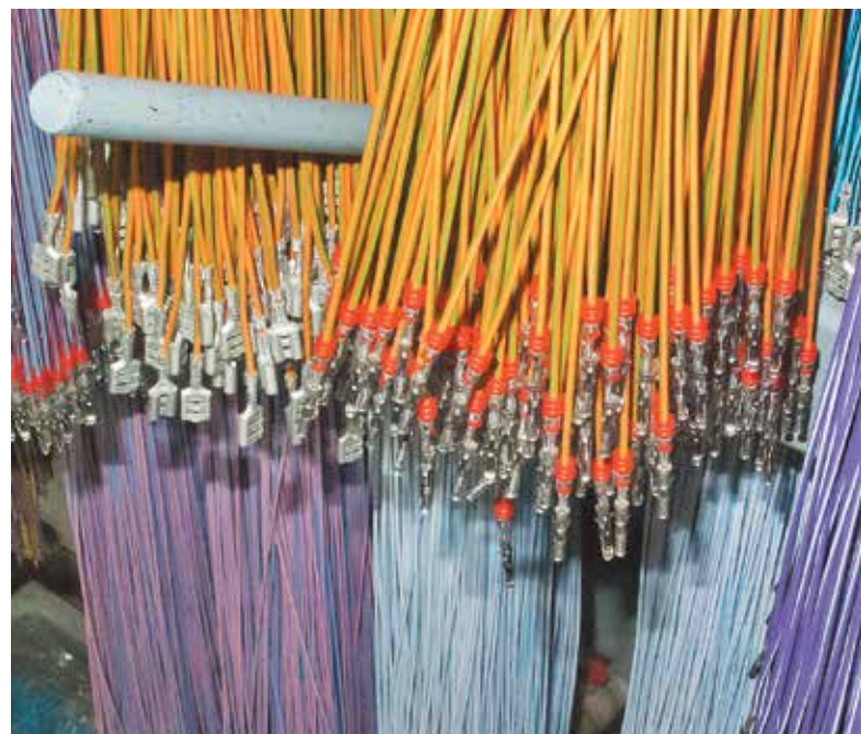
Провода с обжатыми наконечниками и уплотнителями
