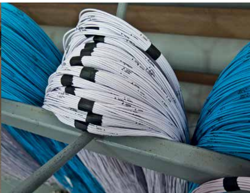
Струйный принтер ims 295 BC для маркировки проводов в составе линии Alpha 355; маркированные провода
