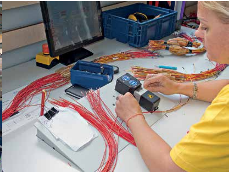
Участок полуавтоматической опрессовки, оснащенный прессами Mecal; установка ультразвуковой сварки
