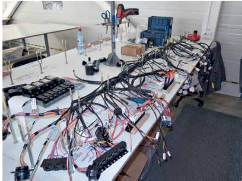
Финальный жгут, подготовленный для подключения к панели
