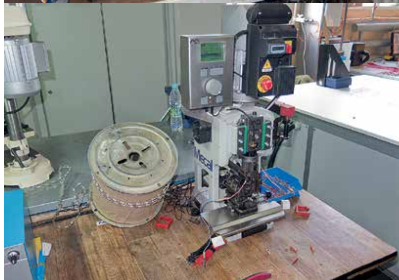
Готовые к использованию аппликаторы (сверху); пресс компании Mecal с контролем усилия опрессовки (снизу)
