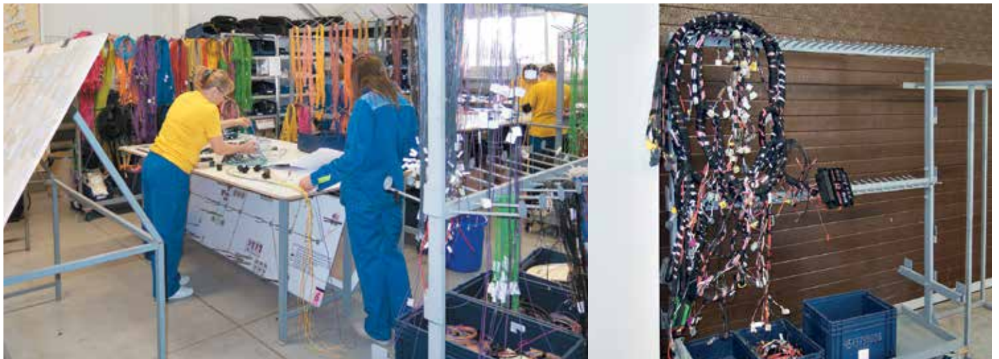
Опытно-промышленный участок. Жгут (справа) включает порядка 900 проводов
