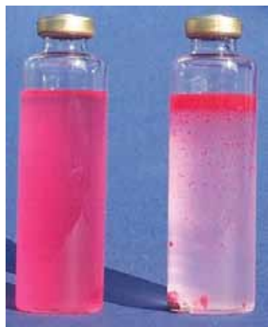
Рис. 5 Растворённые загрязняющие вещества в средстве на основе растворителя (слева) и осажённые загрязняющие вещества в MPC жидкости (справа)
