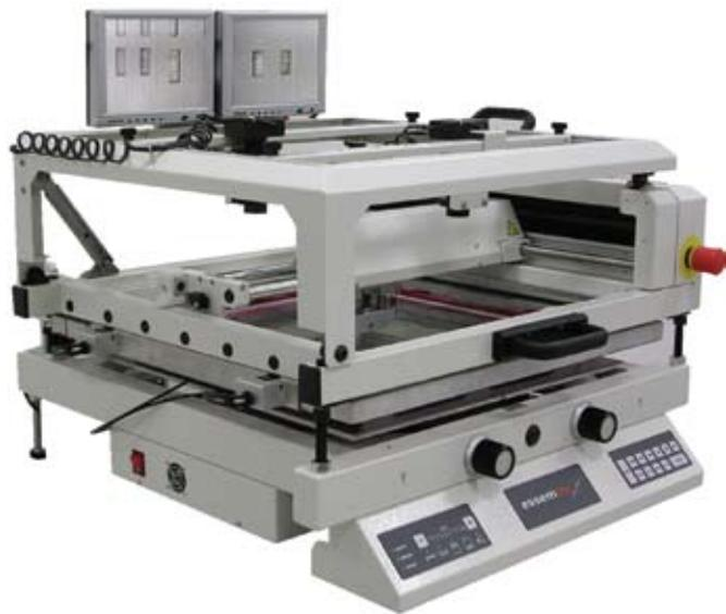
Рис. 1 Полуавтомат трафаретной печати SP003
