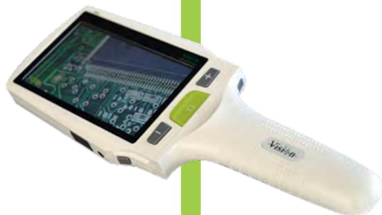
**Видеолупа портативная для визуального контроля CamB с увеличением до 20x предназначена для промышленного применения с возможностью просмотра, захвата изображений, отчетности и документирования.**
