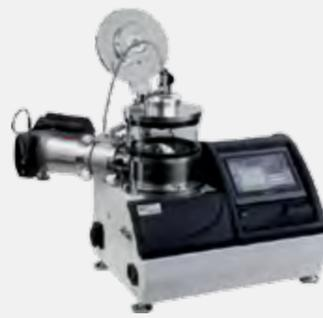
Модель DST Sputter Coater - это специальная система покрытия, которая может покрывать тонкие пленки из благородных металлов, таких как золото (Au), палладий (Pd), платина (Pt), золото / палладий (Au / Pd) и иридий (Ir), а также окислительные покрытия, такие как хром (Cr), вольфрам (W) и другие, на непроводящих или плохо проводящих образцах, как правило, для получения изображений и анализа FE-SEM с высоким разрешением.
