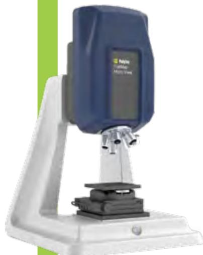
**Компактный и простой в использовании оптический профилометр. Малый размер, расширенные возможности.**
