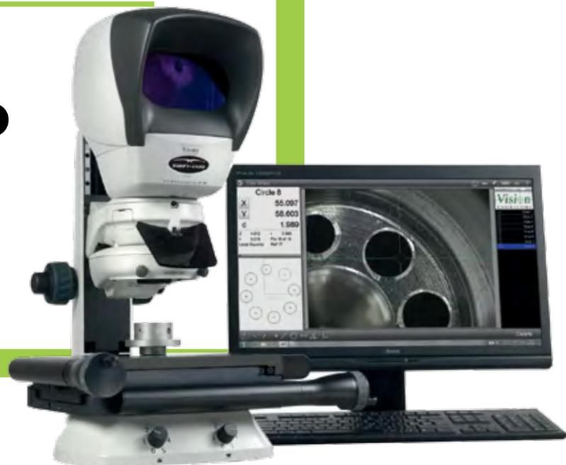
Система бесконтактных измерений - мощная и вместе с тем простая в использовании система для выполнения видеоизмерений, сочетающая новейшие видео- и оптические технологии измерения, и реализованная в виде надежного многоцелевого прибора.
