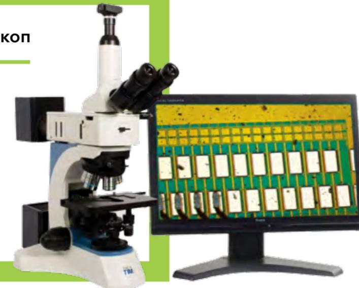
**Предназначен для проведения операций типового контроля. Позволяет выполнять подробный анализ разнообразных материалов – будь то сплавы, пластики, керамика или другие материалы. Операции могут одинаково выполняться как начинающими, так и опытными пользователями.**
