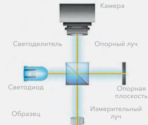
Для структурированных функциональных поверхностей с жесткими допусками требуются высокоточные системы измерения, которые способны быстро сканировать топографию заготовки. Отработанная технология интерферометрии белого света обеспечивает разрешение нанометрового уровня.
