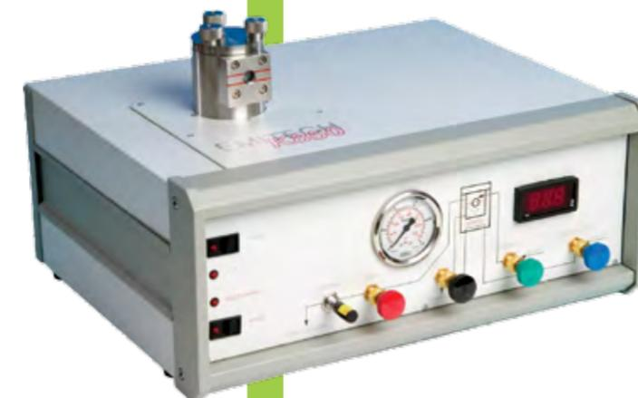
Предназначена для подготовки биологических образцов для исследования под электронным микроскопом в условиях вакуума. Позволяет сохранить структуру образца.
