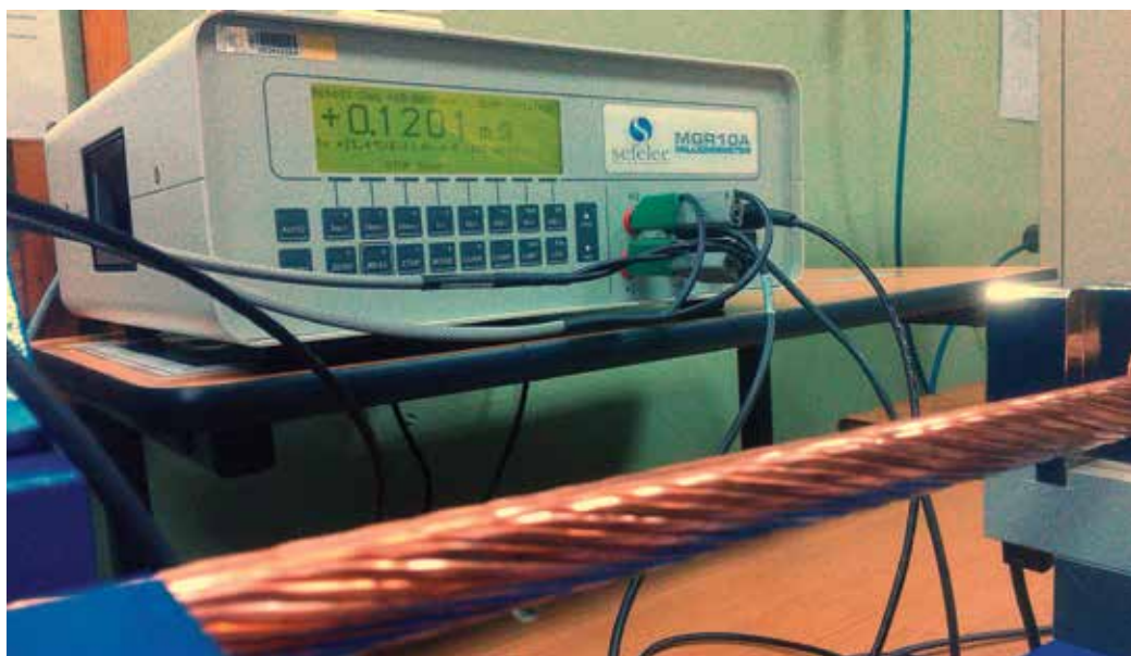
1 Фиксация кабельной жилы (слева) и микроомметр MGR10 (справа)
