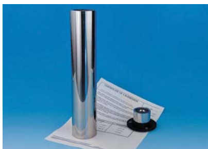
300 / 500 мм образцовый цилиндр для настройки положения колонны
