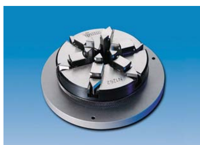
Шестикулачковый зажимной патрон (внут. диам. 20-95 мм, наруж. 2-32 мм)
