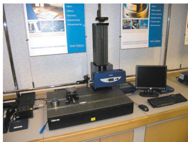
Лабораторный вариант №2 (с гранитным основанием, колонной и стальной станиной)
