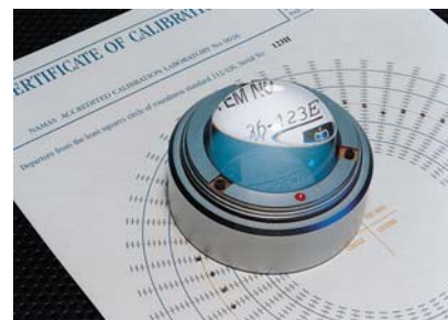
Образцовая сфера для калибровки шпинделя
