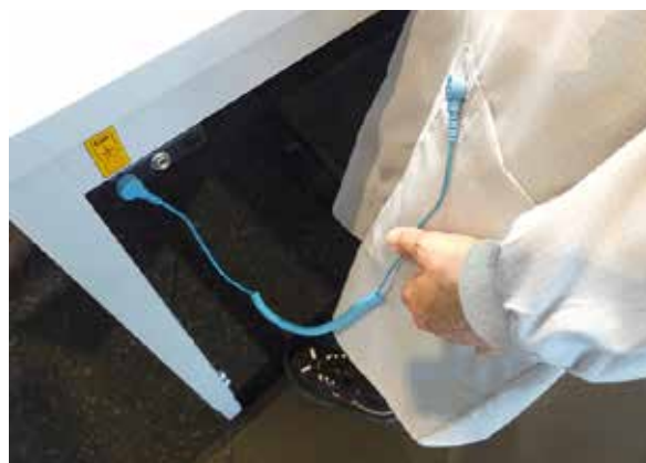
заземление через витой провод
