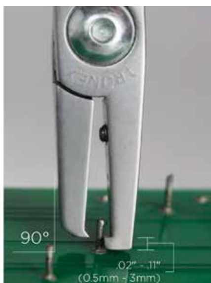
Режущие кромки под углом 90°
