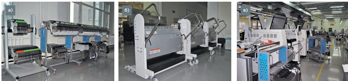
Смена питателей в старых и новых автоматах Samsung: а – подкатные тележки для SM421 и SM451; б – сменные базы питателей для SM471 Plus и SM481 Plus; в – за подкатной тележкой можно видеть сменную базу, подключенную к установщику SM481 Plus
