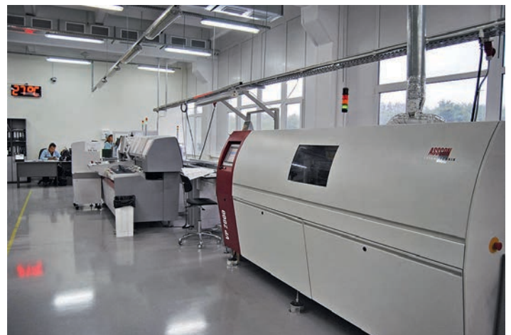
Линия с капле струйным принтером и установщиком компании MYDATA, вид со стороны печи оплавления
