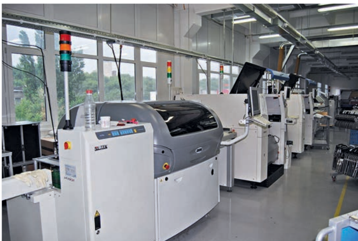
Автоматическая линия поверхностного монтажа с установщиками компании Samsung, работающая с 2006 года
