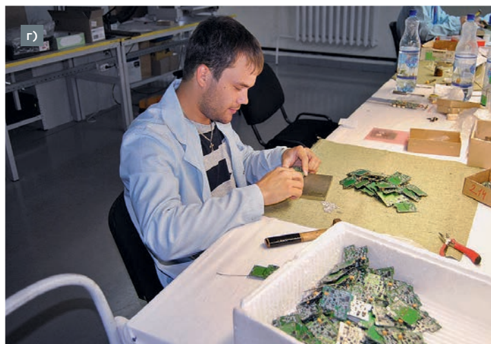
Участок ручного монтажа и слесарной сборки: а – рабочее место ремонта по результатам оптической инспекции; б, в – установка компонентов со штыревыми выводами; г – слесарная сборка
