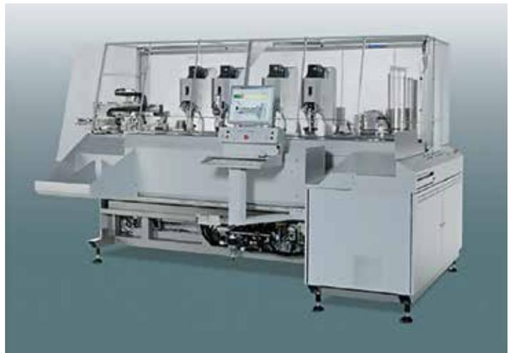
**9** Вариант специальной автоматической линии обработки провода
