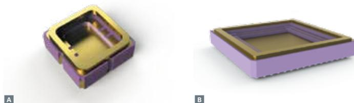
1 Электрические связи внутренних контактных площадок, монтажной площадки и ободка с внешними металлизированными площадками организованы: А через боковые металлизированные отверстия, В через внутренние отверстия, заполненные металлизацией
