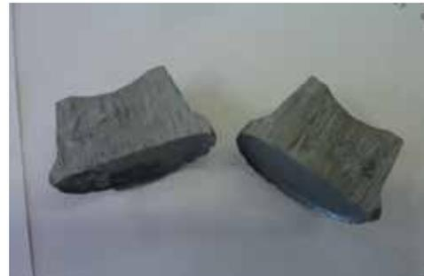
12 Образцы отверждённого материала КДС-174 с введёнными твёрдыми наполнителями
