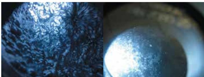
11 Процесс вакуумирования смолы КДС-174 после введения твердого наполнителя
