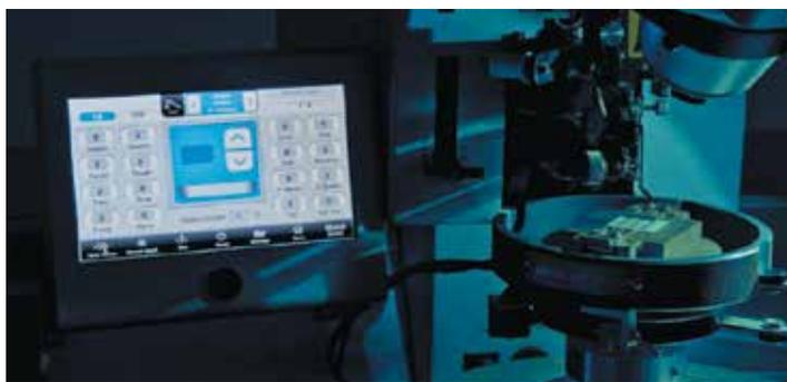
3 Универсальная установка микросварки iBond5000-Dual
