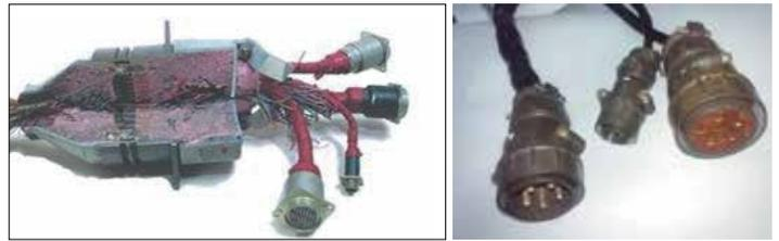
7 Пример применения двухкомпонентного компаунда Виксинт У-2-28
