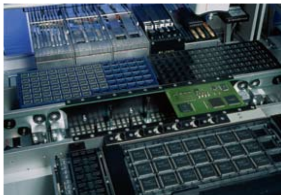
Рис. 7 Стандартные питатели для лент, пеналов, поддонов, обрезков
