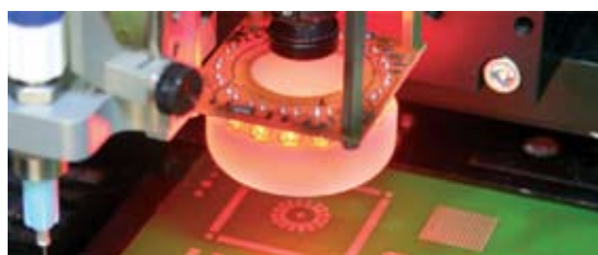
Рис. 10 СТЗ для считывания реперных знаков
