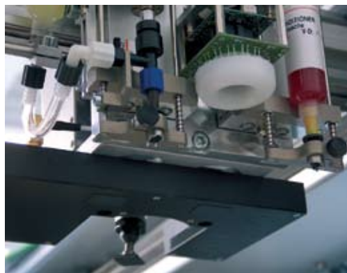
Рис. 13 Дозаторы смонтированные на установочной головке
