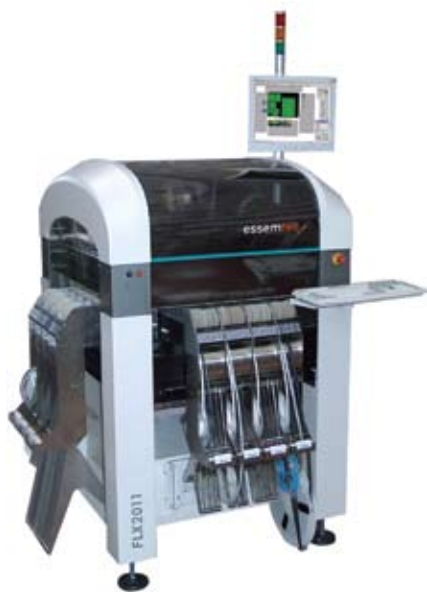
Рис. 1 Универсальный автомат установки компонентов для мелкосерийного производства FLX2011
