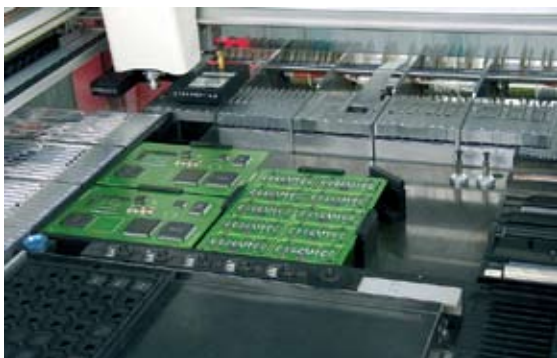
Рис. 5 Подстройка держателей ПУ в автономном или в конвейерном автомате под разные размеры плат чрезвычайно проста и не требует дополнительных инструментов
