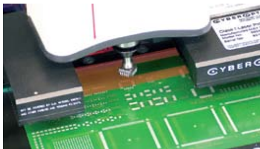
Рис. 11 Лазерная система центрирования «на лету»
