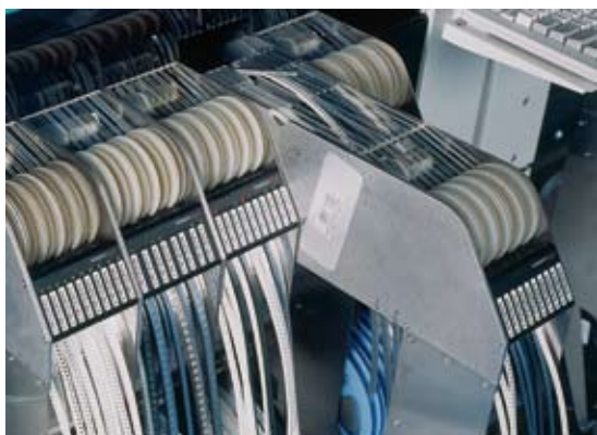
Рис. 6 Перезарядка питателей возможна в процессе работы автомата. Пополнение компонентов возможно непосредственно на базе, при сдвиге питателя в безопасное место
