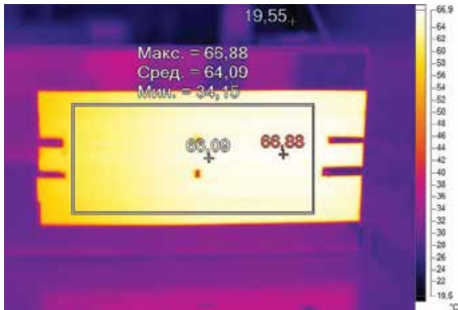
3 Процесс испытаний печатной платы на тепловой режим
