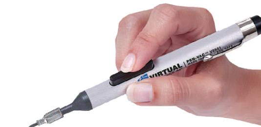
Вакуумный пинцет PEN-VAC является самодостаточным устройством, не требующим источников питания или шлангов, мешающих в работе. Идеален для захвата SMD-компонентов и плоских деталей, имеющих не пористую поверхность. Иголки и присоски могут храниться в корпусе вакуумного пинцета.
