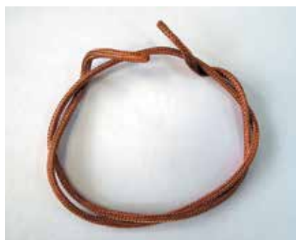
1 Плетенка из алюминиевых сплавов, изготовленная на установке Cobra 1000
