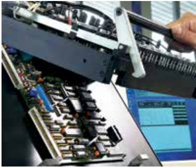
1 Установка электрического тестирования с адаптером типа «ложе гвоздей»
