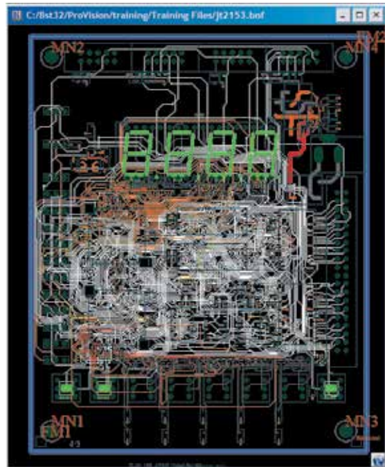
4 Графический результат анализа тестового покрытия печатного модуля (белым цветом выделено 100%-ное покрытие, серым — его отсутствие)
