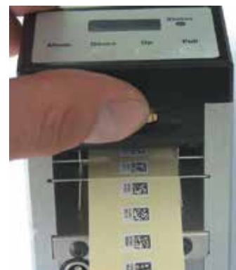
И в конце, регулируем боковые прижимы по ширине. Питатель готов к работе. Как мы видим, ничего сложного с точки зрения зарядки нет, а подача этикетки в зону забора в процессе работы происходит автоматически.
