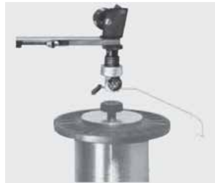
5 Система сбора с катушки лужёной медной проволоки
