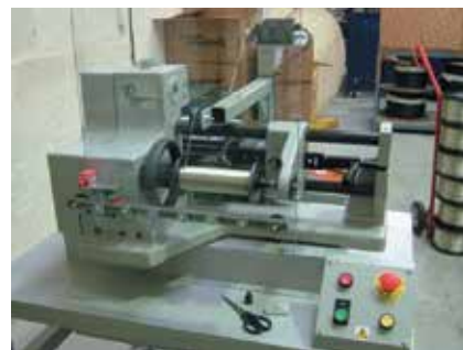
6 Станок тростки лужёной медной проволоки со стандартных катушек на пластиковую катушку установки Cobra 1000
