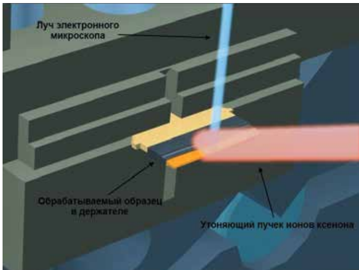
3 Обработка образца в установке Xact (упрощенное изображение)
