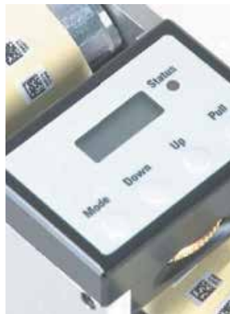
Пропускаем ленту под основным модулем (предварительно прокрутив регулировочное колесо до положения «максимум»). После этого протягиваем ленту под планкой.
