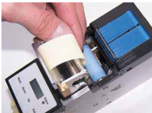
Уводим подложку под прижимной ролик, закрываем крышку. Таким образом, при работе лента будет утягиваться вниз, а этикетка специальными щеточками подаваться на транспортную ленту. В принципе почти все так же, как на обычном питателе.
