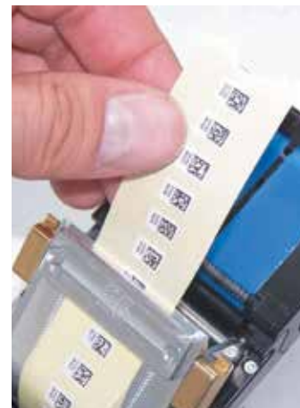
Пропускаем ленту под основным модулем (предварительно прокрутив регулировочное колесо до положения «максимум»). После этого протягиваем ленту под планкой.
