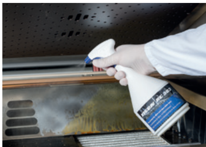
2 Удаление загрязнений в печи оплавления с помощью Vigon RC® 303
