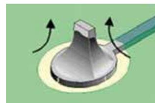
Для образования правильной формы галтели, жало паяльника должно двигаться вверх вдоль вывода элемента.
