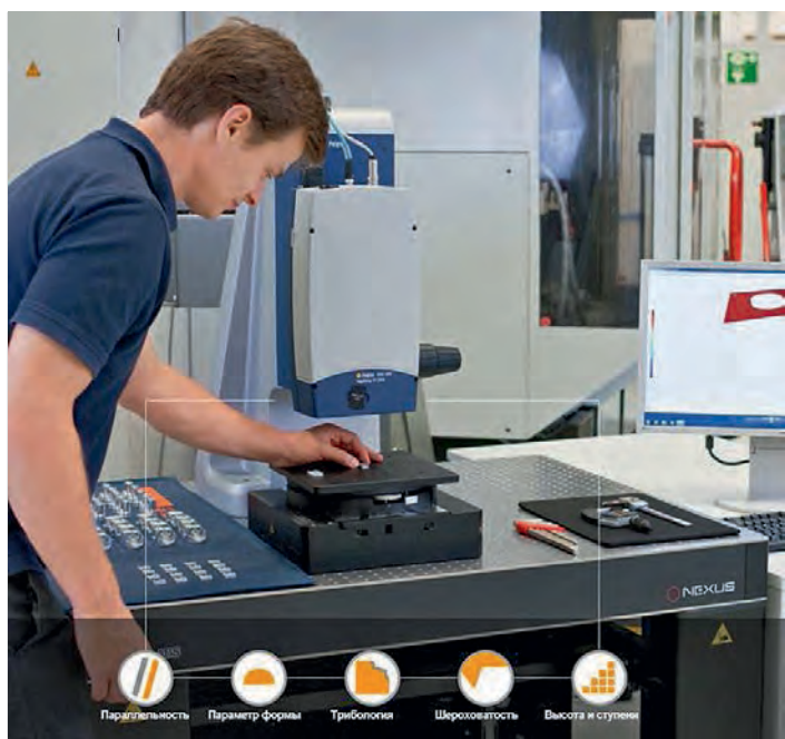
Применение интерферометра белого света в лаборатории ОТК
