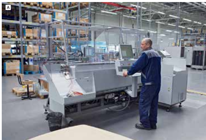
Автоматическая линия Zeta 633: А — с лицевой стороны; В — со стороны системы подачи проводов
