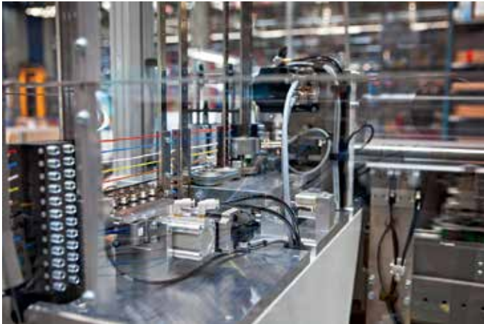
Система подачи проводов и мерной резки Zeta 633. Слева — селектор выбирает один из проводов; справа — шкивы с ремнями протягивают провод через ролики рихтовки; за шкивами — ролик энкодера, отмеряющего заданную длину провода
