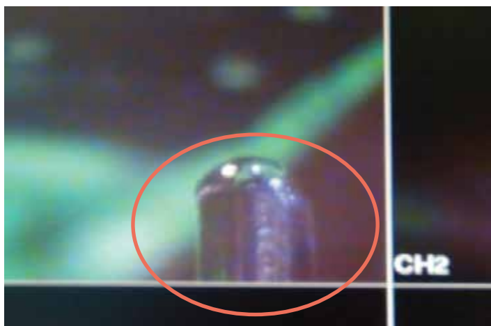
3 Неправильная форма миниволны при пайке на окисленных волнообразователях
