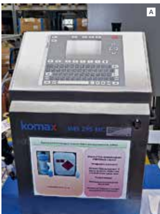
А — принтер маркировки проводов Komax IMS 295 MC; В — перехватывающие захваты (шаттлы); С — ножевой блок
