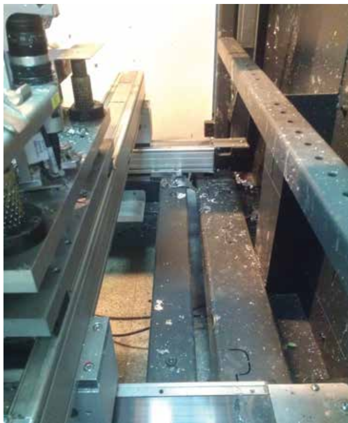
Разбрызгивание припоя на участке селективной пайки 1
