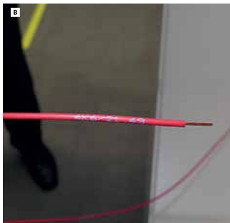
Обработка концов проводов: A — модуль ультразвуковой сварки; B — вывод после УЗ-сварки; C — вывод, армированный наконечником
