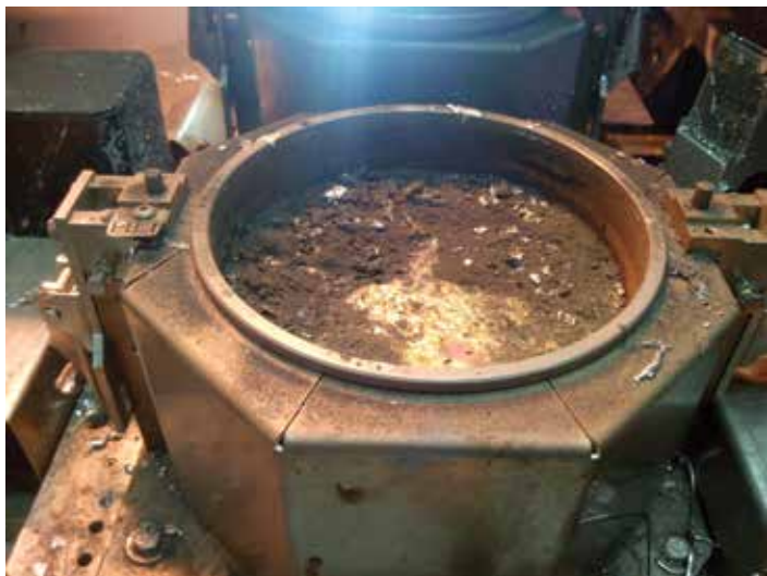
Разбрызгивание припоя на участке селективной пайки 1
