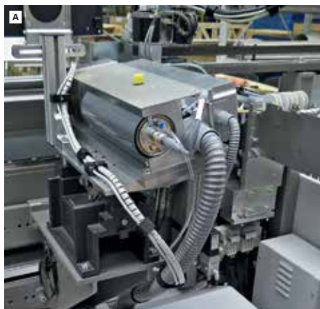
Обработка концов проводов: A — модуль ультразвуковой сварки; B — вывод после УЗ-сварки; C — вывод, армированный наконечником
