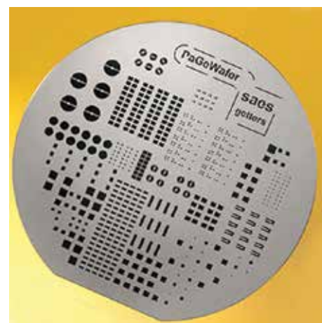
10 Кремниевая пластина фирмы SAES Getters со сформированным рисунком тонкоплёночного геттера для корпусирования на уровне пластины 14
