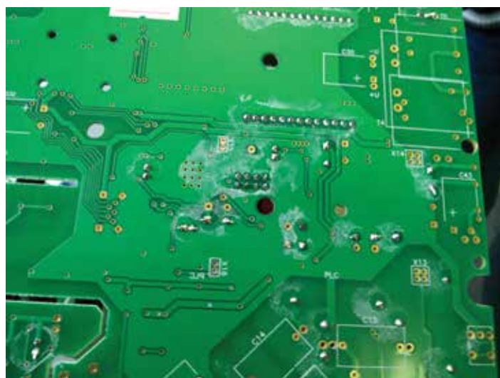
5 Белый налет на поверхности печатного узла
