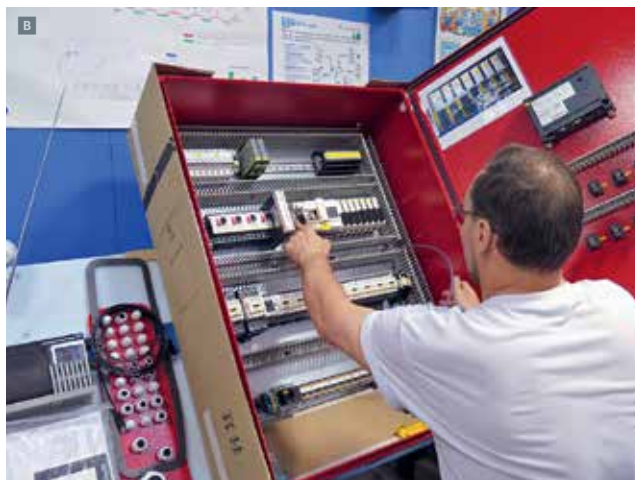
Сборка шкафов управления: A — монтажная плата в шкафу; B — кабельные каналы и компоненты (на монтажной плате — на DIN-рейках, на передней панели — на резьбовых заклепках); C — смонтированный шкаф
