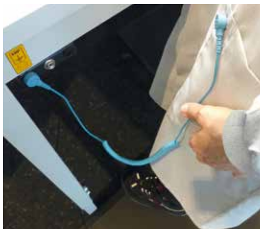
заземление через витой провод
