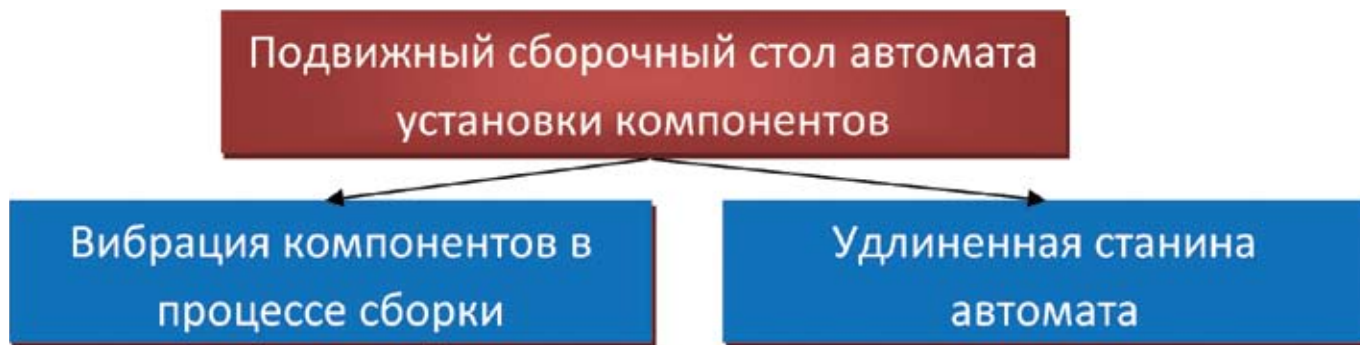
Рис. 7 Основные недостатки конструкции автоматов установки компонентов с подвижным сборочным столом в контексте перехода на бессвинцовую технологию
