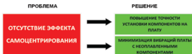
Рис. 2 Направления внесения изменений в конструкцию автоматов установки компонентов, вызванные внедрением бессвинцовой технологии
