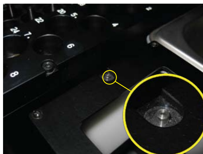
Рис. 5 Реперные точки для калибровки автомата в режиме реального времени автомата SM-421
