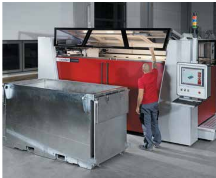
4 Принтер VX2000. На переднем плане — сменный рабочий короб
