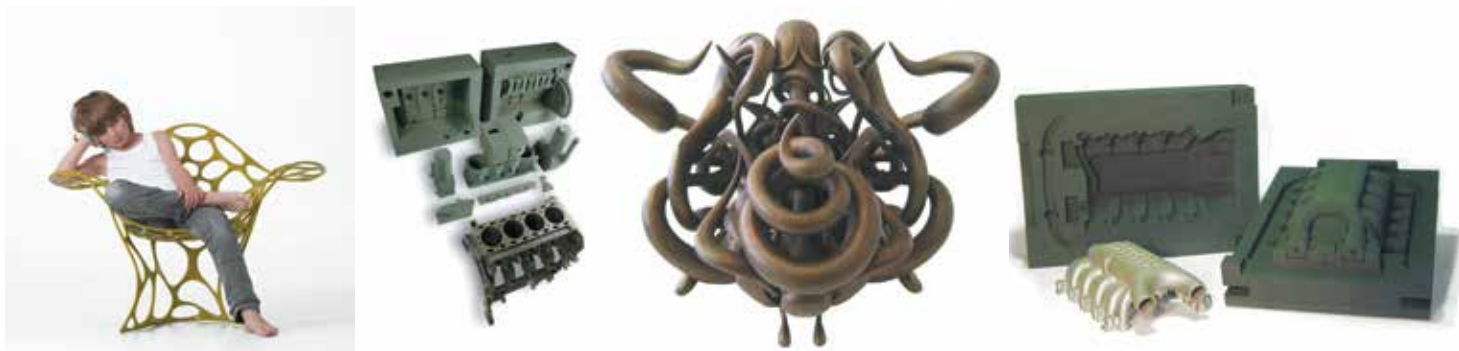
13 Образцы изделий, литейные формы для которых напечатаны на 3D-принтере voxeljet — от сложной дизайнерской конструкции и дизайнерского алюминиевого кресла до узлов двигателей
