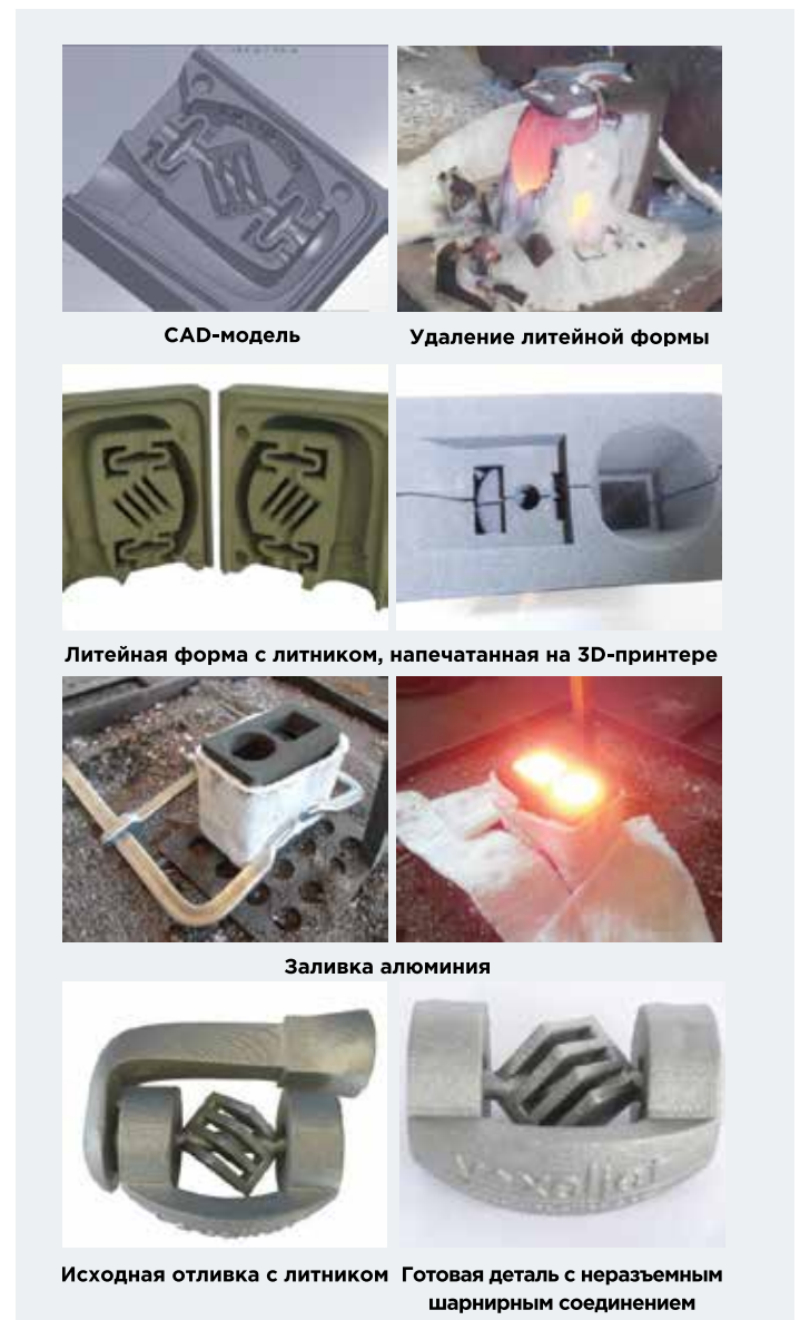
12 Отливка на основе песчаных литейных форм, напечатанных на 3D-принтере voxeljet
