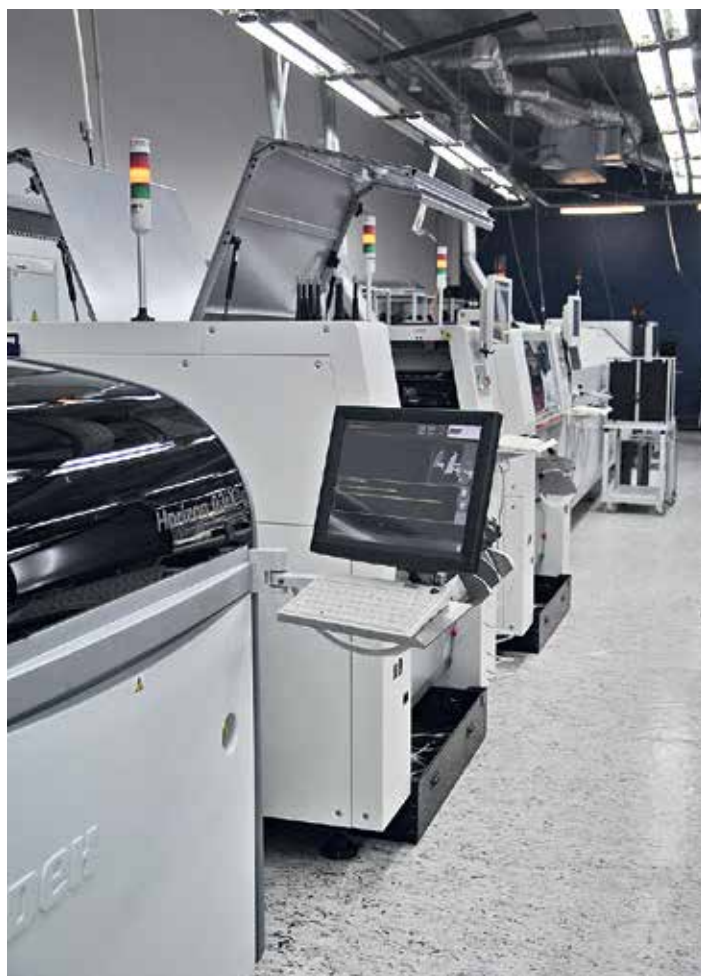
1 Автоматическая линия поверхностного монтажа в цехе компании «ПСБ технологии»
