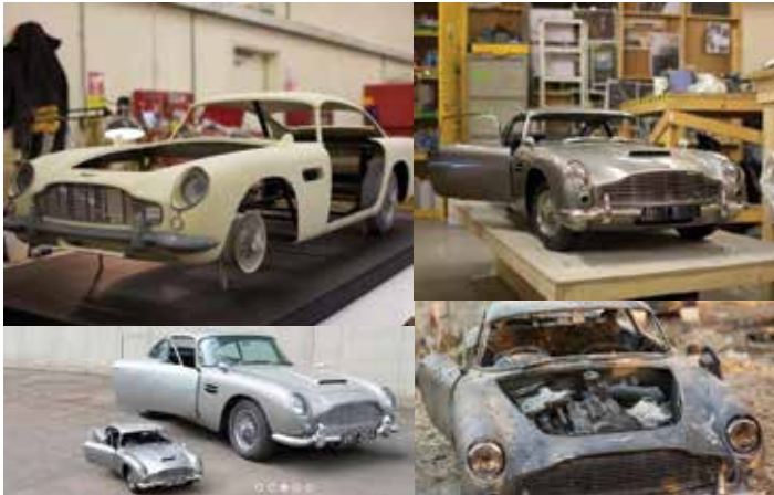
11 Пластиковая модель 1 : 3 легендарного автомобиля Джеймса Бонда Aston Martin DB5 для фильма «007. Координаты: «Скайфолл», напечатанная на VX1000
