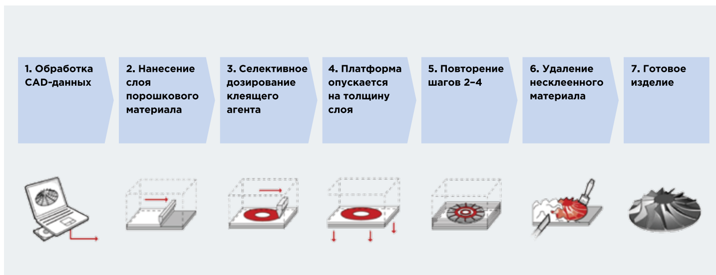
1 Принцип 3D-печати по технологии voxeljet
