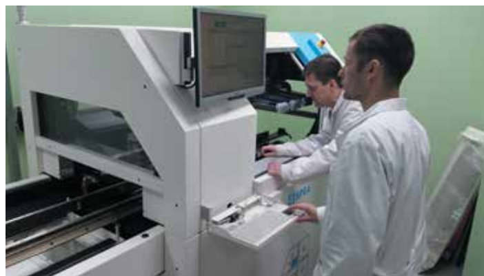
3 Специалисты анализируют дефект платы, загруженной в SPEA 4060
