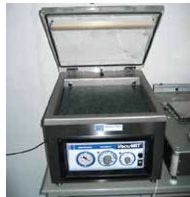
9 Установка вакуумирования керамических карт в герметичный пакет
