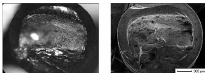
25 Изображения в оптическом (слева) и электронном (справа) микроскопах одного поля зрения
