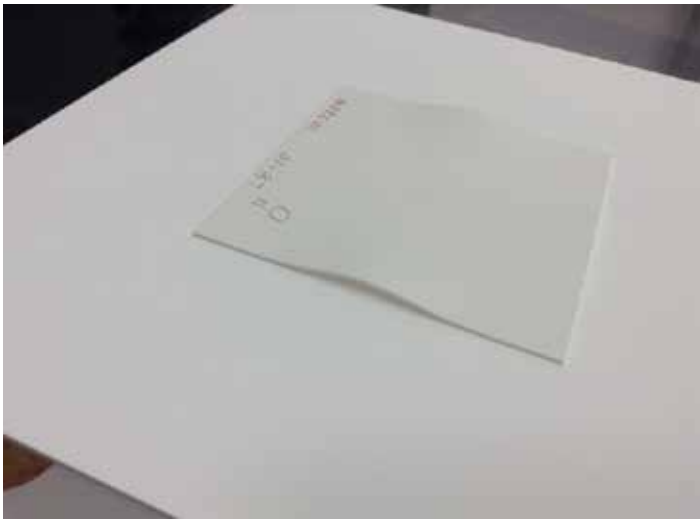
3 Пример деформации LTCC-платы после обжига. Металлизация отсутствует
