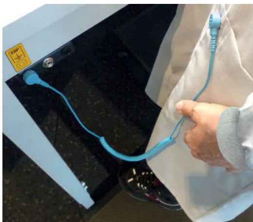
заземление через витой провод
