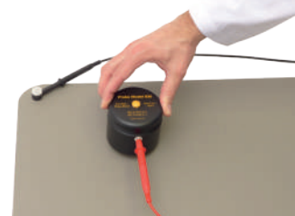
Пример использования: измерение цилиндрическим электродом
