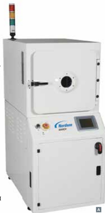
7 Установка плазменной очистки AP-1000: А — общий вид; В — рабочая камера
