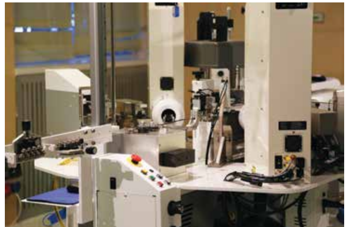
4 Роботизированный комплекс обработки провода (РКОП) с модулями лазерной зачистки, флюсования и лужения
