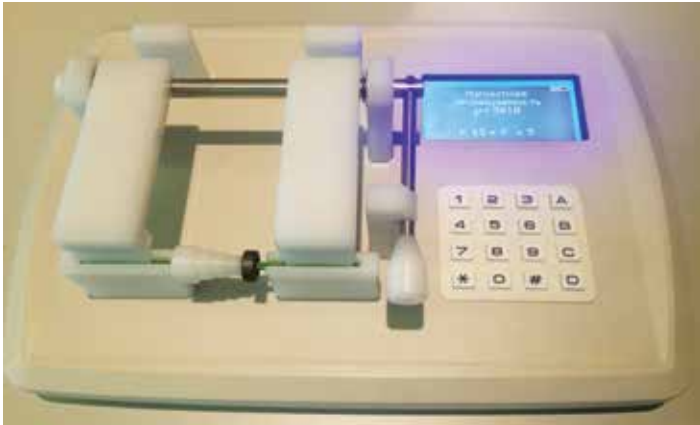
2 Измеритель параметров ферромагнитных сердечников тороидальной формы типа Ш1-23 ЛДПА.411174.001ТУ
