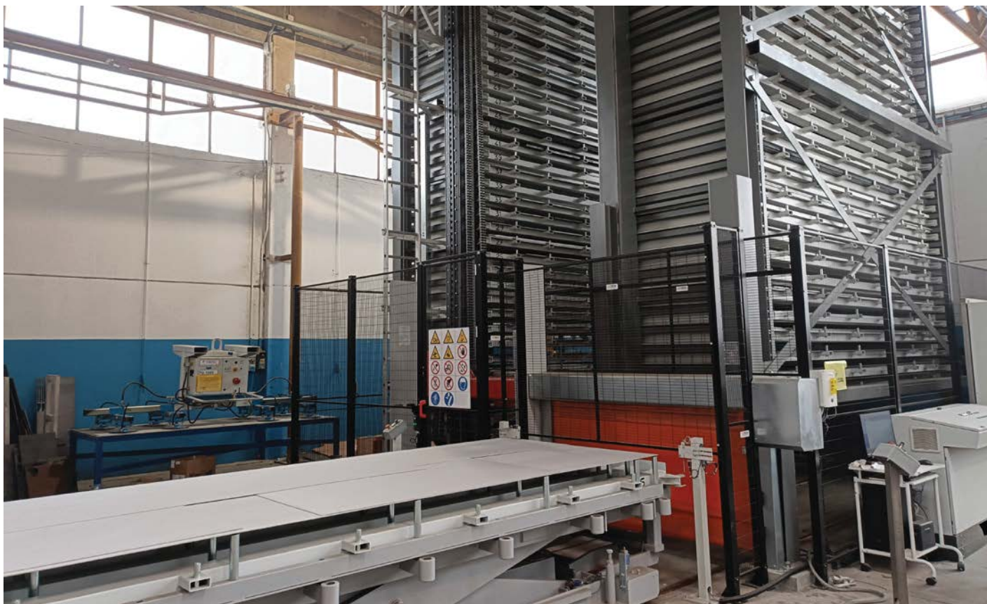
Вертикальные системы хранения листового и профильного металла Steel Tower
