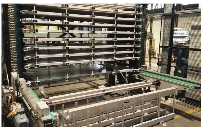
Автоматизированная система хранения металлических листов, сложенных в стопки / пакетное хранение (отрасль механической обработки)
