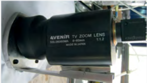
Видеосистема обзора внутрикамерного оборудования
