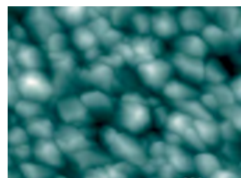
Высокоориентированный пиролитический графит с медным покрытием в электрохим.ячейке
