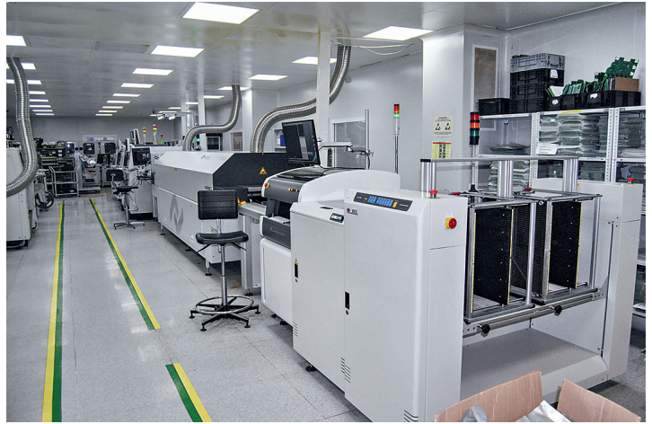
Линии поверхностного монтажа на сборочно-монтажном производстве АО «Рязанский Радиозавод»
