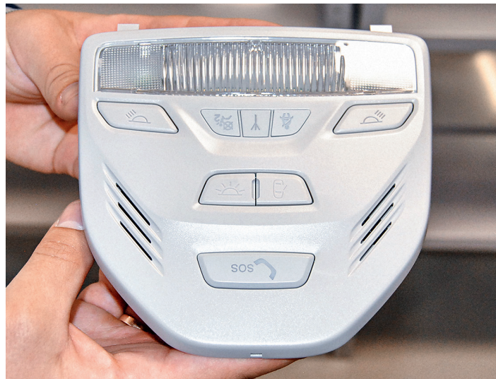
Готовый блок для салона автомобиля с системой экстренного вызова «ЭРА-ГЛОНАСС»
