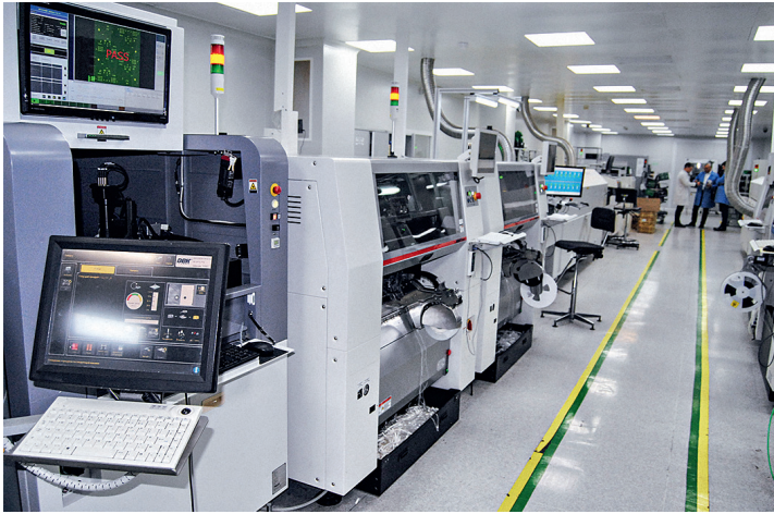
Линии поверхностного монтажа на сборочно-монтажном производстве АО «Рязанский Радиозавод»
