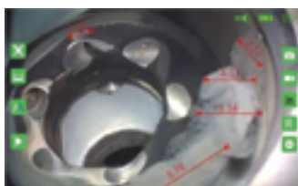
Функции измерения от точки до линии, от точки до плоскости (опционально)
