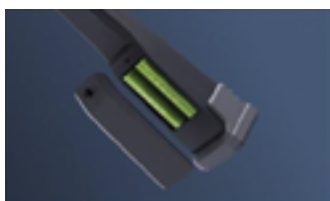
Используются 4 элемента питания типа 18650 Время работы ≥8 ч
