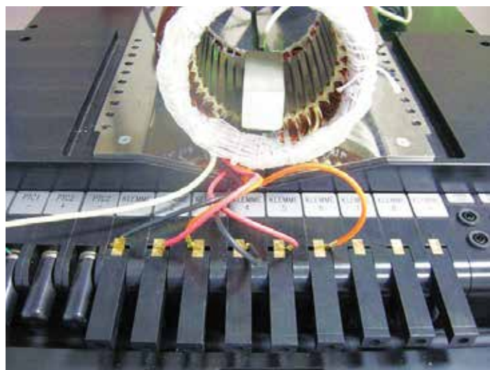
6 Крокодилы Кельвина, расположенные рядом. На фото видны две отдельные изолированные друг от друга части клеммника
