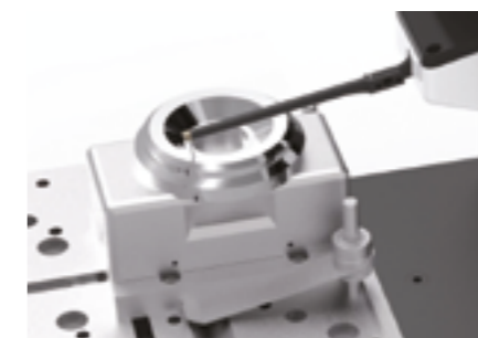
Измерение контура и шероховатости автомобильных деталей
