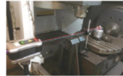
Измерение поворотной оси на станке с числовым программным управлением
