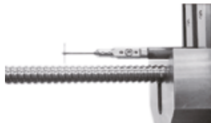
Тестирование шарико- винтовой пары
