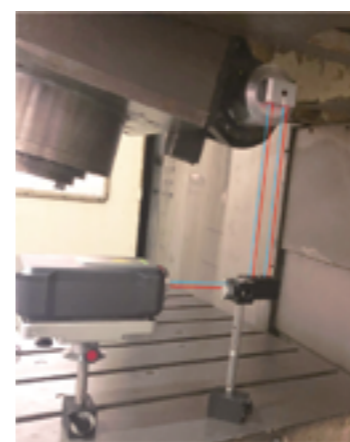
Измерение угла индексирующей пластины с числовым программным управлением
