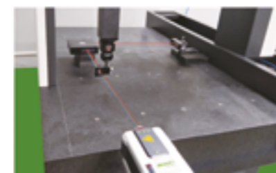
Трёхкоординатное измерение перпендикулярности
