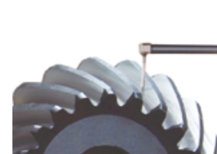
Измерение поверхности зуба шестерни Ra
