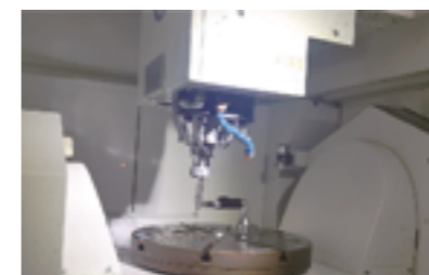
Измерение округлости станка (рис. 1)
