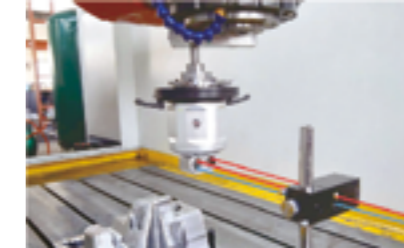
Измерение электрического шпинделя на станке с числовым программным управлением
