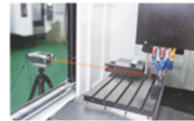
Линейное измерение контрольного станка
