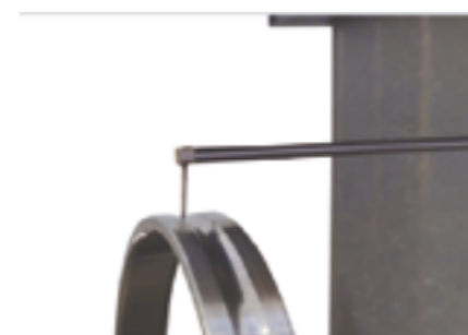
Измерение дорожки качения подшипника Pt, Ra
