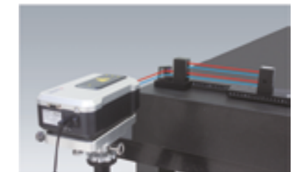
Измерение плоскостности мраморной платформы
