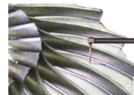
Измерение поверхности лопасти Ra
