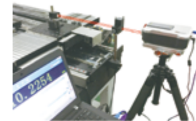
Измерение точности позиционирования линейного модуля
