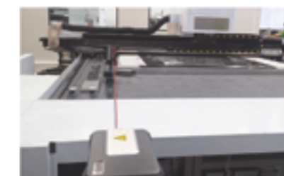
Измерение прямолинейности оборудования
