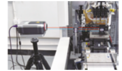
Измерение угла двигателей с прямым приводом
