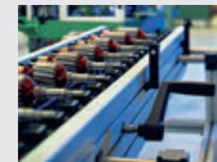
Готовые роторы электродвигателя на выходном конвейере
