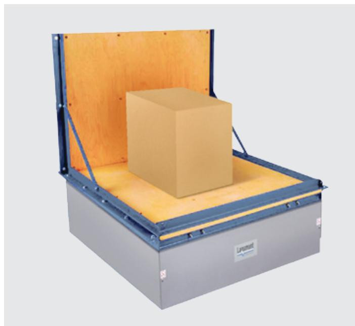
3 Электро-механический стенд Lansmont MS 400
