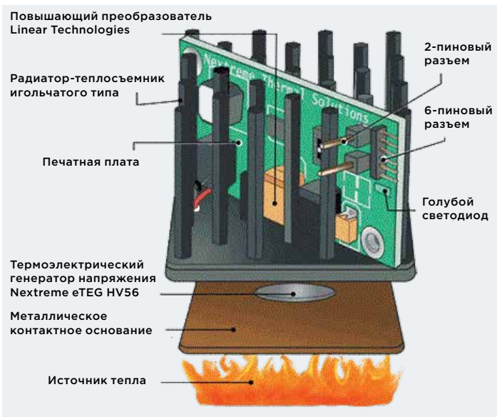
8 Структура беспроводного генератора энергии WPG-1
