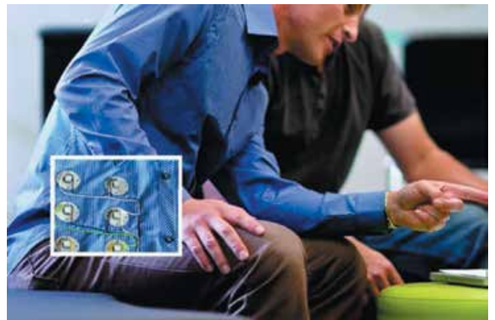
13 Набор генераторов, вшитый в рубашку
