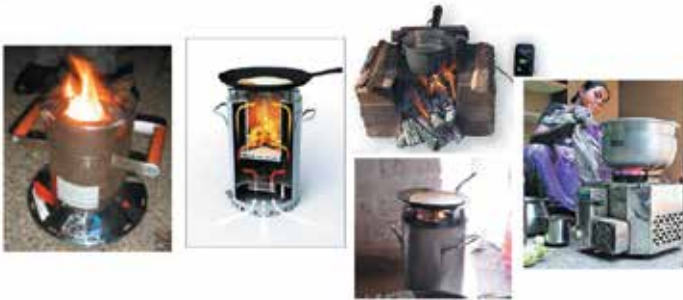
7 Харвестер, вырабатывающий энергию при горении огня: совмещены процессы приготовления пищи на огне и выработки электроэнергии
