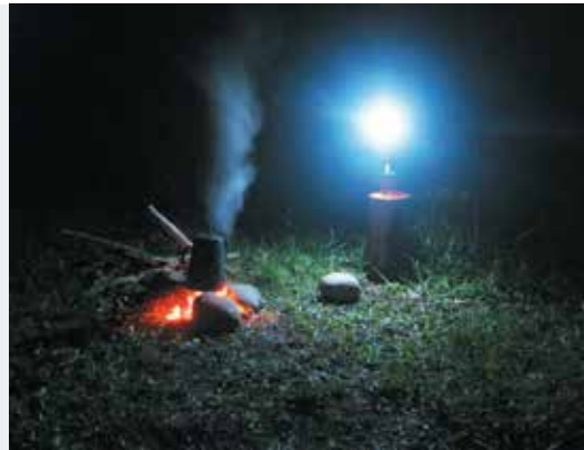
12 Пример работы tPOD1 от свечи, установленной вну- три, и от костра, греющего его снаружи
