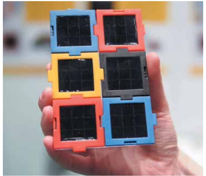
5 Набор небольших квадратиков с солнечными батареями, которые как пазл можно объединять в большую структуру
