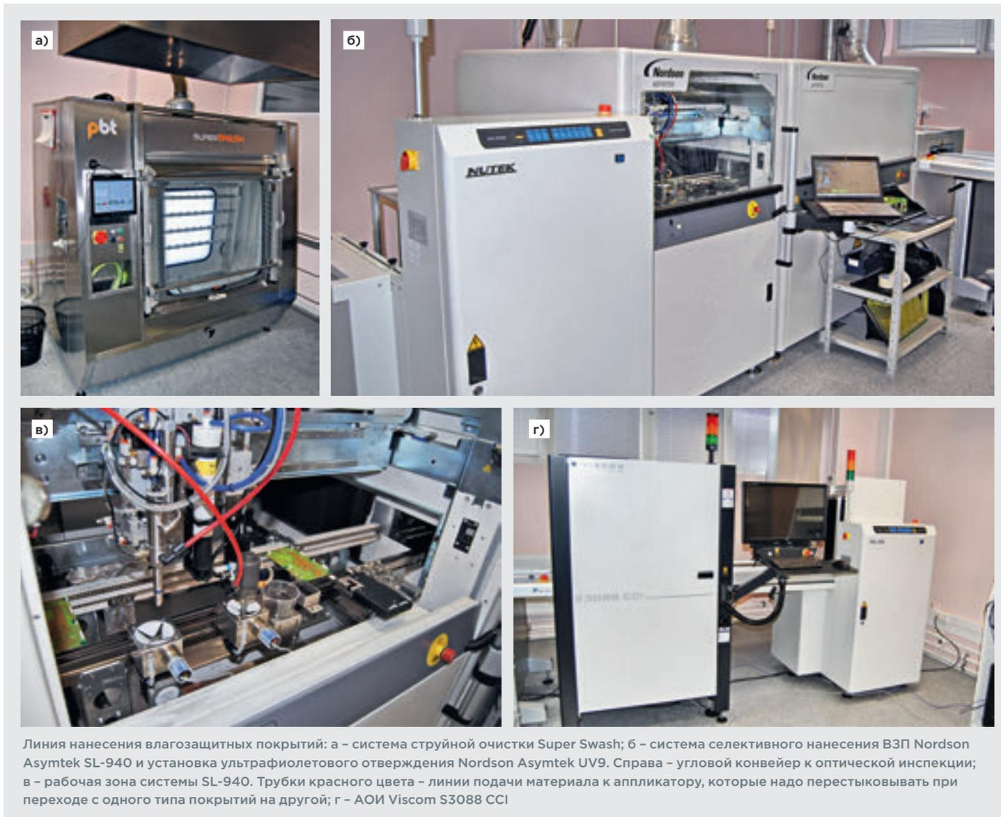
Линия нанесения влагозащитных покрытий: а – система струйной очистки Super Swash; б – система селективного нанесения ВЗП Nordson Asymtek SL-940 и установка ультрафиолетового отверждения Nordson Asymtek UV9. Справа – угловой конвейер к оптической инспекции; в – рабочая зона системы SL-940. Трубки красного цвета – линии подачи материала к аппликатору, которые надо перестыковать при переходе с одного типа покрытий на другой; г – АОИ Viscom S3088 CCI
