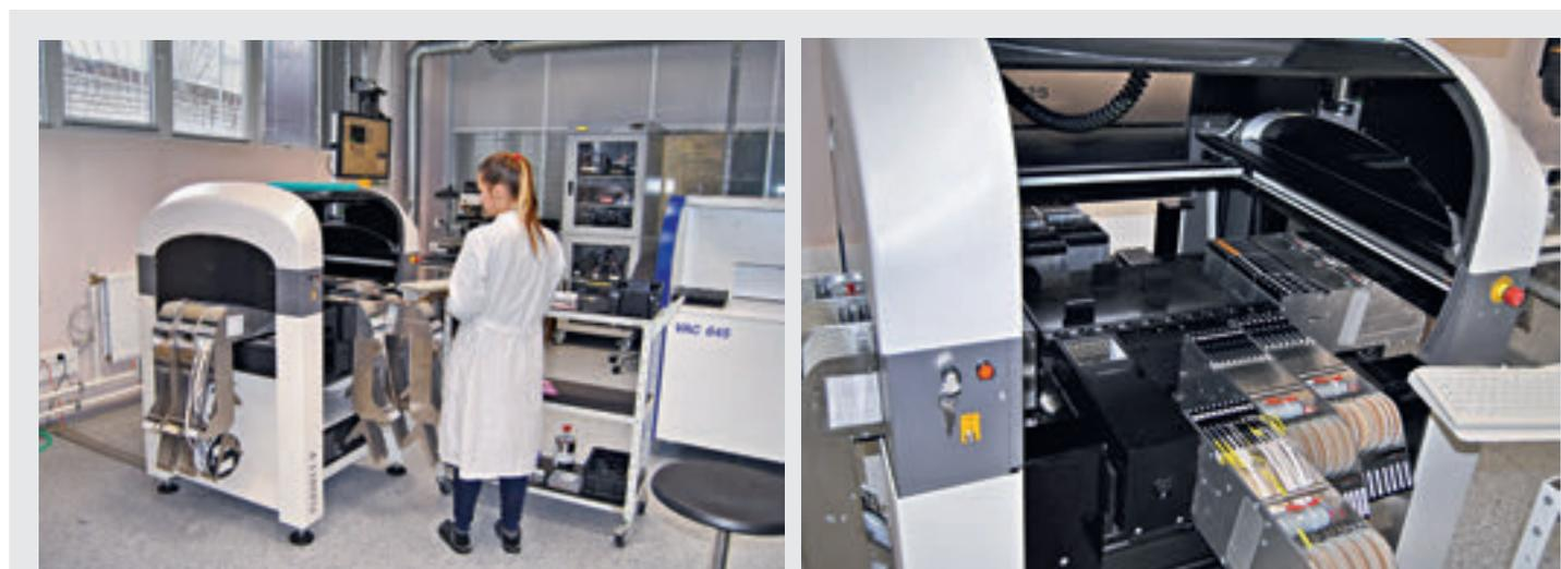
Автомат поверхностного монтажа Essemtec FLX 2011 V
