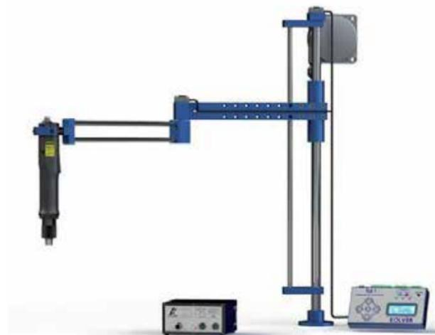
Шарнирный манипулятор TLS1/LINART с системой позиционирования оснащён контроллером TLS1 и датчиками положения, что позволяет в режиме реального времени отслеживать координаты шуруповёрта и избежать ошибок во время сборки изделий. Это важно при выполнении операций, требующих соблюдения последовательности завинчивания.
