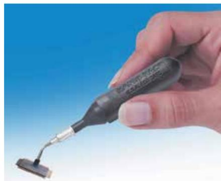
HANDI-VAC - это экономичный вариант вакуумного пинцета, предназначенного для захвата и удержания SMD компонентов, пластиковых частей и металлических деталей, имеющих гладкую непористую поверхность. Данный вакуумный пинцет может работать с присосками диаметром от 2.38 мм до 19.05 мм. Для крупных элементов рекомендуется использовать присоски большего размера. Присоски изготовлены из проводящей резины.
