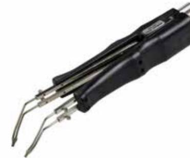
Двухконтурный импульсный пинцет CT-15 обеспечивает быстрый разогрев наконечников и безопасную пайку/выпайку SMD-компонентов, таких как Chip компоненты и микросхемы с двухсторонним расположением выводов, где длительный нагрев может привести к повреждению их схемы. Подключается к универсальному кабелю с быстроразъёмным соединением. Работает с импульсной станцией SMR или ремонтным центром PRC2000.
