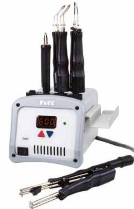
Станция SMR имеет импульсный источник питания, обеспечивая контролируемое нарастание температуры до точки плавления, уменьшая риск термошока и нежелательный нагрев соседних паяных соединений. Станция может быть использована для снятия и установки небольших SMD-компонентов, термозачистки изоляции проводов, ремонта проводников и контактных площадок печатных плат, а также для удаления конформных покрытий. Поставляется с импульсным съёмником изоляции TS-15.
