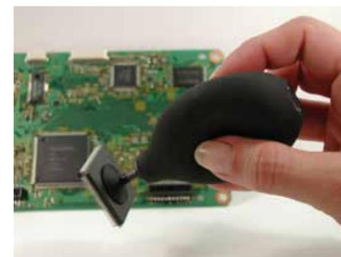
Вакуумный пинцет BULB-VAC™ относится к экономичным решениям для захвата и установки компонентов. Эти устройства работают также просто, как и обычные пинцеты. Просто сожмите колбу, поместите присоску на компонент и расслабьте сжатие колбы. Ваш компонент будет захвачен. Повторное нажатие освобождает компонент от захвата. При помощи данного инструмента можно захватить компоненты весом до 113 грамм.
