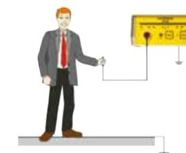
Измерение напряжения на теле персонала:
