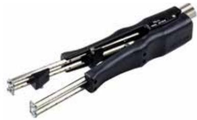
Импульсный съёмник изоляции TS-15 позволяет быстро и безопасно снять изоляцию с провода, включая тефлоновую. Доступны различные наконечники с калиброванными пазами для проводов от 18 GA до 24 GA. На съёмнике имеется шкала в миллиметрах и дюймах, нанесённая лазерной гравировкой, и упорный ограничитель, что позволяет выставить длину зачистки провода. Подключается к универсальному кабелю с быстроразъёмным соединением. Работает с импульсной станцией SMR или ремонтным центром PRC2000.
