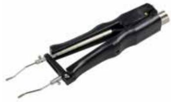
Одноконтурный импульсный пинцет TW-15 предназначен для пайки/выпайки проводов в разъёмах с высокой плотностью штырьков, терминалов и наконечников. Вы захватываете элемент в холодном состоянии, нажимаете ножную педаль и узел быстро разогревается. При этом исключён риск загрязнения терминала припоем. Подключается к универсальному кабелю с быстроразъёмным соединением. Работает с импульсной станцией SMR или ремонтным центром PRC2000.
