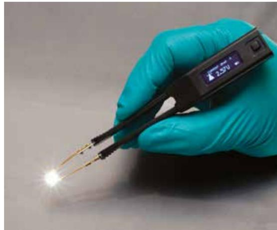
Smart Tweezers® Iskra™ – специализированное решение для тестирования и проверки светодиодов, как в SMD исполнении, так и выводных. Устройство конструктивно объединяет позолоченные щупы в виде пинцета и цифровой тестер светодиодов в виде компактного, легкого прибора с батарейным питанием.
