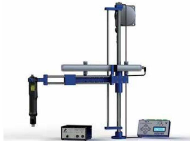
Линейные манипуляторы TLS1/LINAR1 и TLS1/LINAR2 с системой позиционирования оснащены контроллерами TLS1 и датчиками положения, что позволяет в режиме реального времени отслеживать координаты шуруповёрта и избежать ошибок при сборке изделий. Это важно при выполнении операций, требующих соблюдения последовательности завинчивания.
