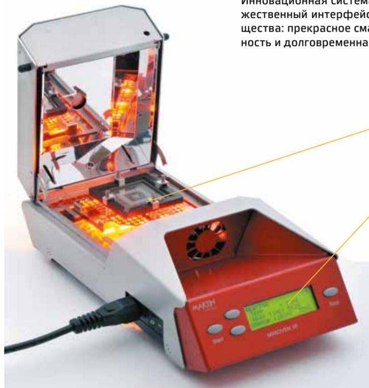
Нижний ИК-нагреватель мощностью 500 Вт
