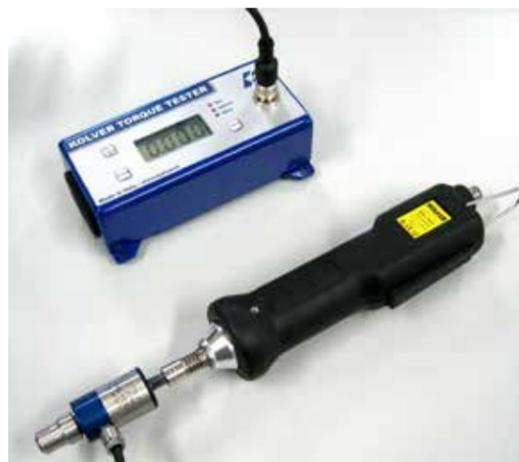
Измерители крутящего момента Серии MINI KE/S состоят из считывателя крутящего момента и внешнего поворотного преобразователя. Внешний преобразователь является идеальным инструментом для проверки фактического крутящего момента в соединении. При помощи внешнего поворотного преобразователя, расположенного между электрическим или пневматическим шуруповёртом и точкой приложения усилия, можно определить реальный крутящий момент, передаваемый инструментом на крепёж или винт.
