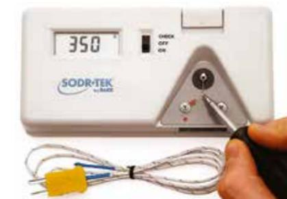
Измеритель температуры – это быстрый и точный способ измерить температуру поверхности жала паяльника. Данная температура является фактической в месте пайки. Регулярный контроль температуры наконечника гарантирует, что оборудование работает с заданными параметрами и отвечает условиям техпроцесса.
