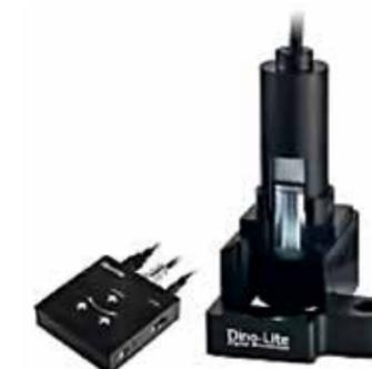
**KM-01:** устройство дистанционной регулировки фокуса
