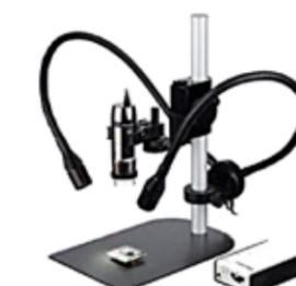
**PH-HSP:** набор высокомощной светодиодной точечной подсветки с 2 осветителями и переходником для штатива MS35/36B(E)
