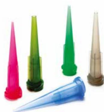
Конические иглы серии ТТ изготовлены из полиэтилена с УФ-блокаторами. В основании конуса имеется втулка с люэровским соединением с двойной резьбой, что обеспечивает надежное присоединение к картриджу.
