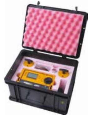
Тестовый набор Metriso® B530 включает: цифровой мегомметр, 2 пробника Модель 870 со стержнем-удлинителем, ручной электрод с соединительным кабелем, руководство пользователя, сертификат калибровки, проводящий кейс для переноски с размещенным внутри порошком, рассеивающим статические заряды.
