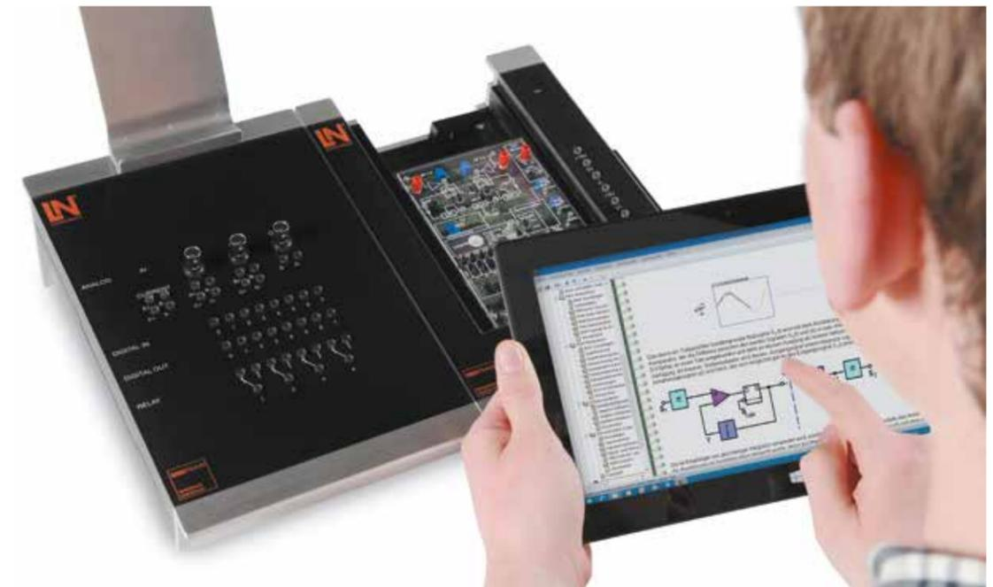
UniTrain – мультимедийная система электронного обучения с интегрированной мобильной электронной лабораторией, предназначенная для обучения и повышения квалификации в области электротехники и электроники.
