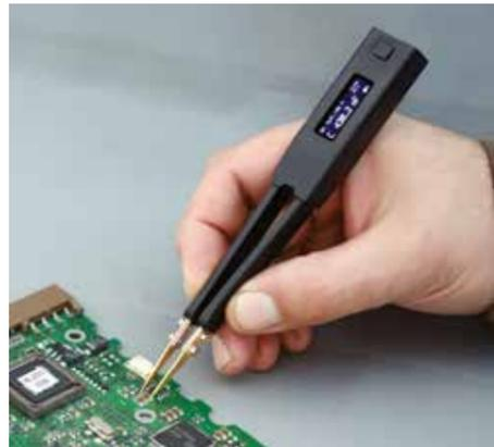
Smart Tweezers™ – портативный LCR-метр нового поколения. Smart Tweezers™ существенно облегчает решение задачи идентификации и измерения компонентов для поверхностного монтажа, а также при поиске неисправностей в сложных электронных приборах.
