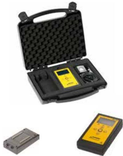
Легкий ручной прибор с ЖКИ дисплеем для измерения поверхностного сопротивления.
