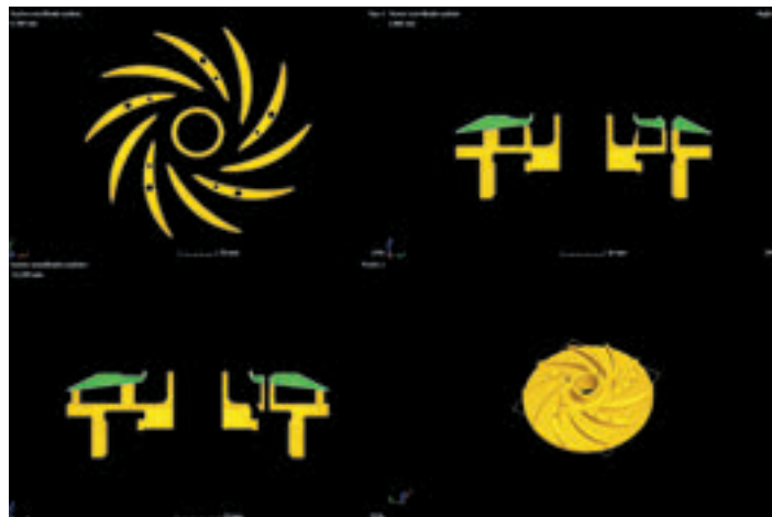
6 Результаты сканирования образца «Колесо рабочее» с помощью системы компьютерной томографии v|tome|x m300
