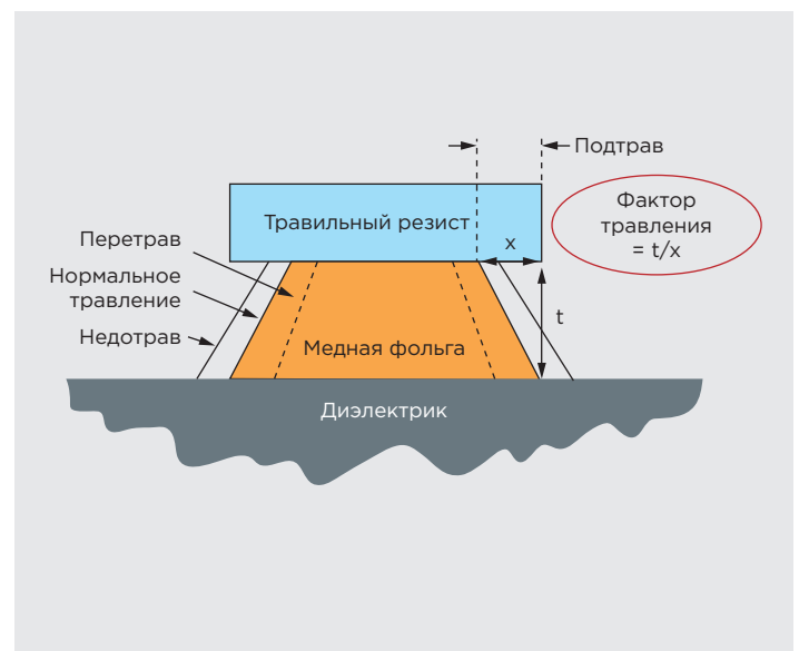
Определение фактора подтравливания проводников печатных плат
