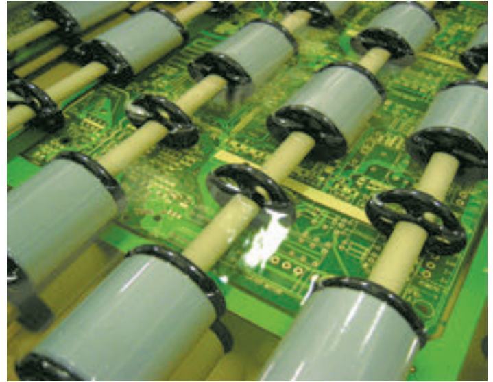
10 Осаждение иммерсионного олова на линии горизонтального типа
