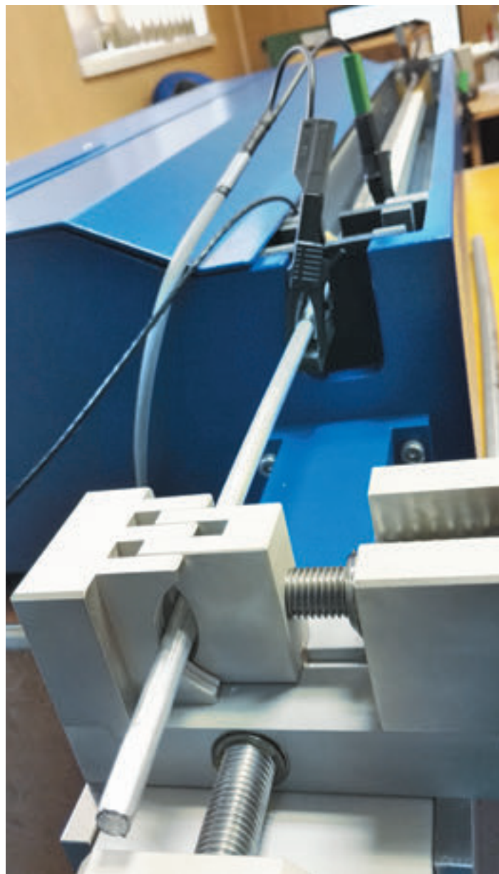
Зажим алюминиевой катанки в испытательной ванне
