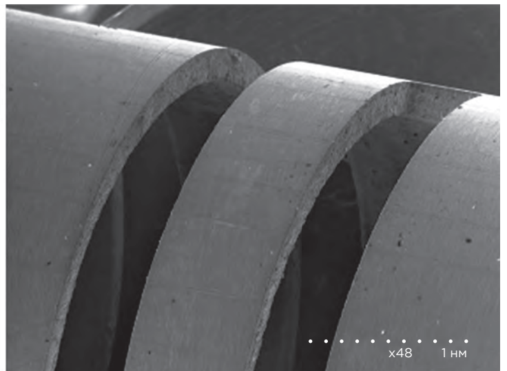
6 Микрофотография поперечного реза стальной трубки, полученного на установке лазерной резки Sigma, без дальнейшей обработки поверхности. Из архива компании Amada Miyachi
