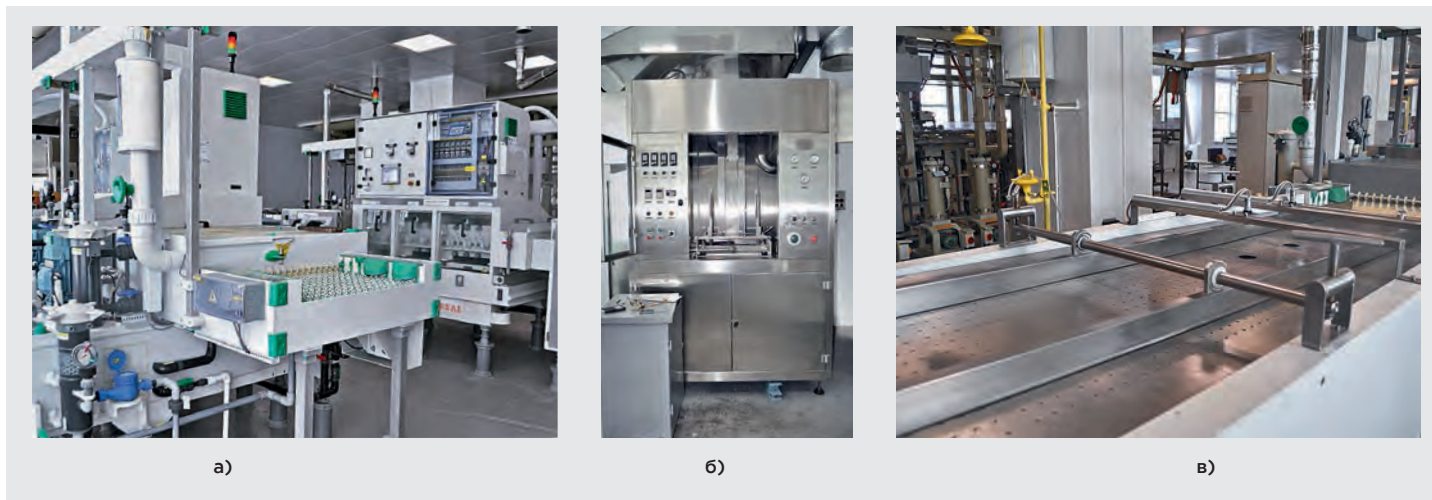
8 HASL-процесс: а – линия подготовки поверхности и флюсования (на переднем плане), установка финишной отмывки; б – установка горячего лужения производства китайской компании Dalux LTD; в – перфорированный наклонный конвейер, на котором плата остывает после прохождения воздушных ножей. Направляющие конвейера регулируются по ширине платы
