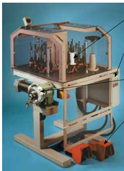
«Шпули» с катушками Блок управления и контроля Устройство автоматической намотки оплетаемого жгута Педаля управления
