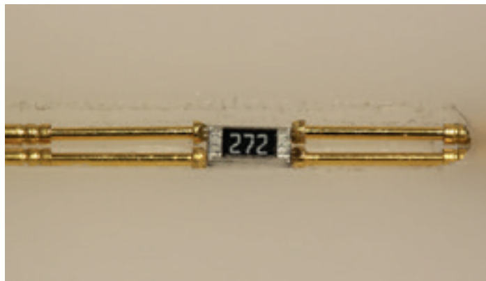
Принцип контактирования в адаптере. Верхние запирающие крышки сняты
