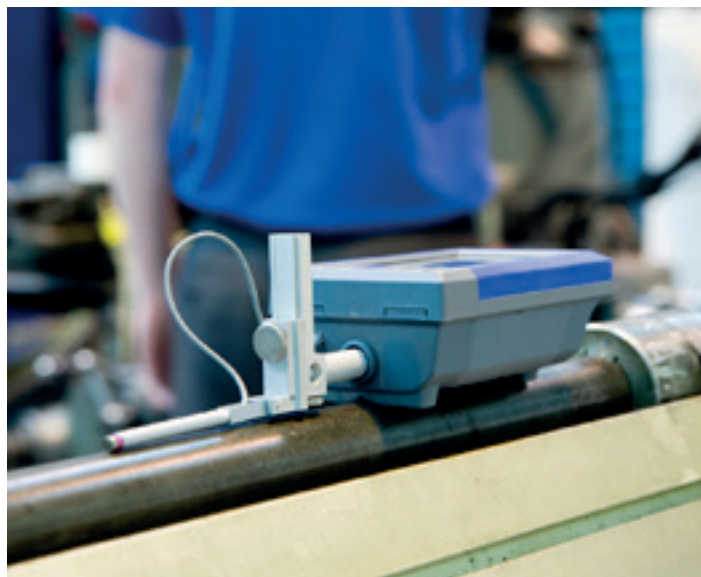
Surtronic S-100 в процессе измерения шероховатости стальной трубы
