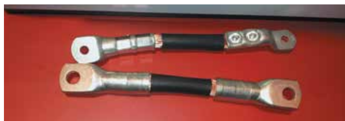
9 Образец провода, опрессованный на оборудовании WDT
