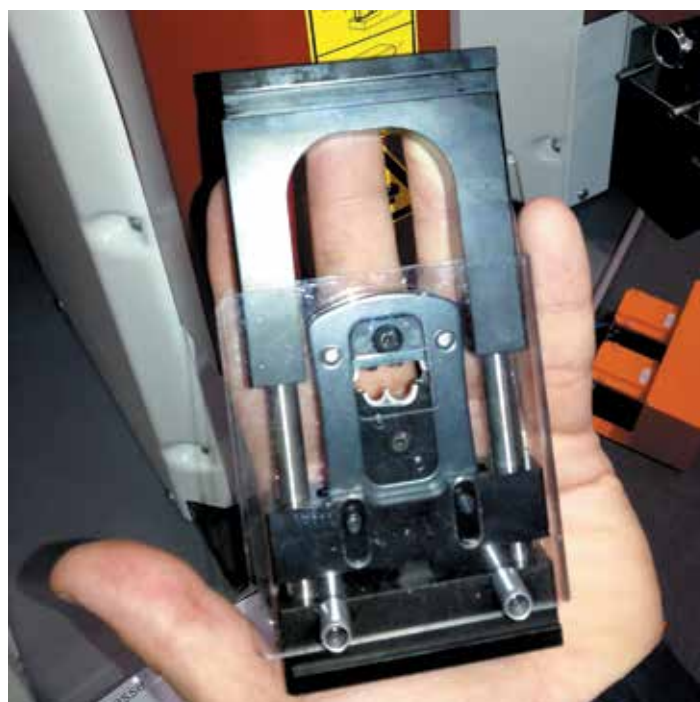
8 Сменная матрица машины опрессовки контактов WDT
