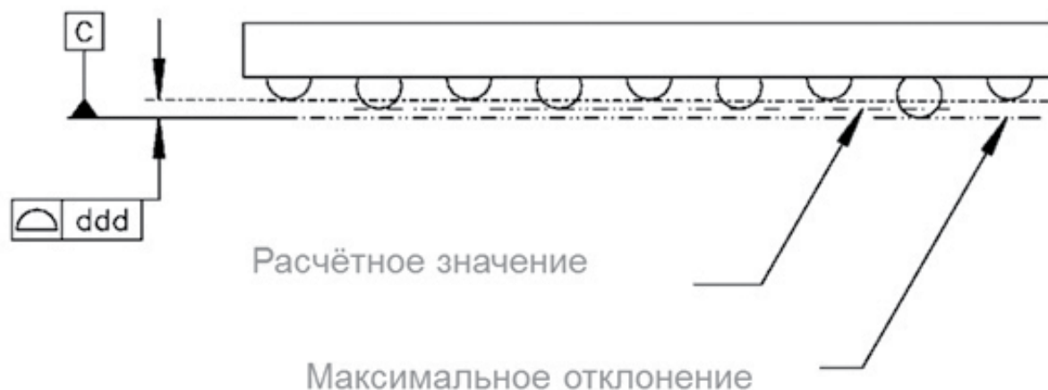
Рис. 5 Отклонение шариковых выводов интегральных микросхем в корпусах BGA ( \mu BGA) от компланарности (по данным JEDEC Publication 95 Design Guide 4.22)
