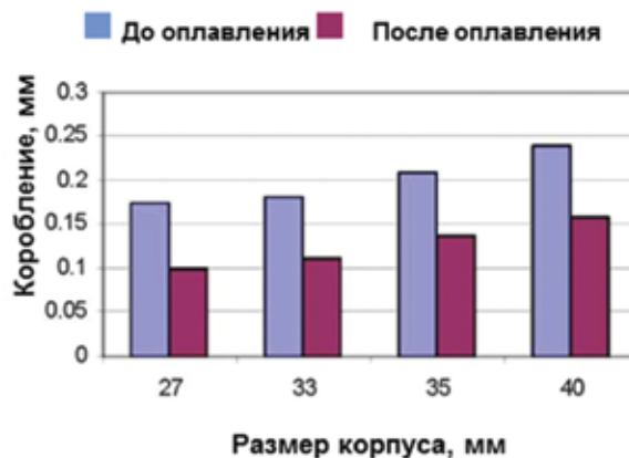
Коробление подложки до и после оплавления
