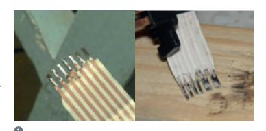
Примеры обработанных ленточных проводов с помощью «обжигалок»
