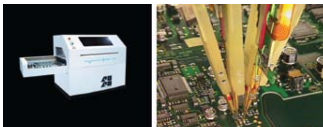
Рис. 3 Система автоматического внутрисхемного и функционального контроля с "летающими" щупами SPEA 4040 гарантирует надёжную диагностику и точную локализацию дефектов за счёт измерения параметров каждого компонента печатного узла
