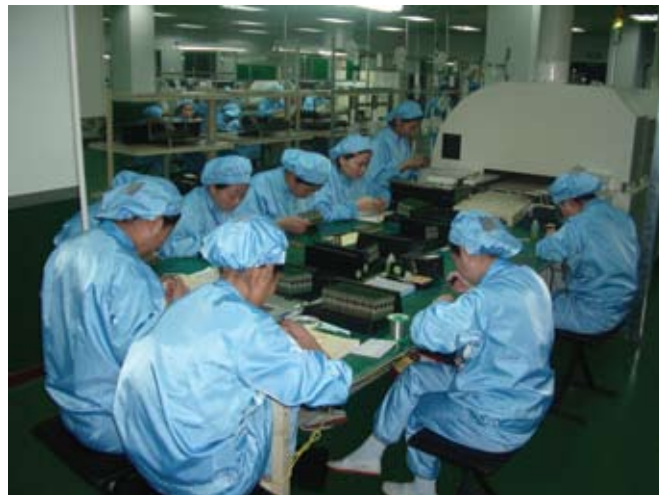
Рис. 1 Тотальный визуальный контроль печатных узлов после пайки. Широко распространённый в начале века в Китае метод, основанный на низкой заработной плате персонала
