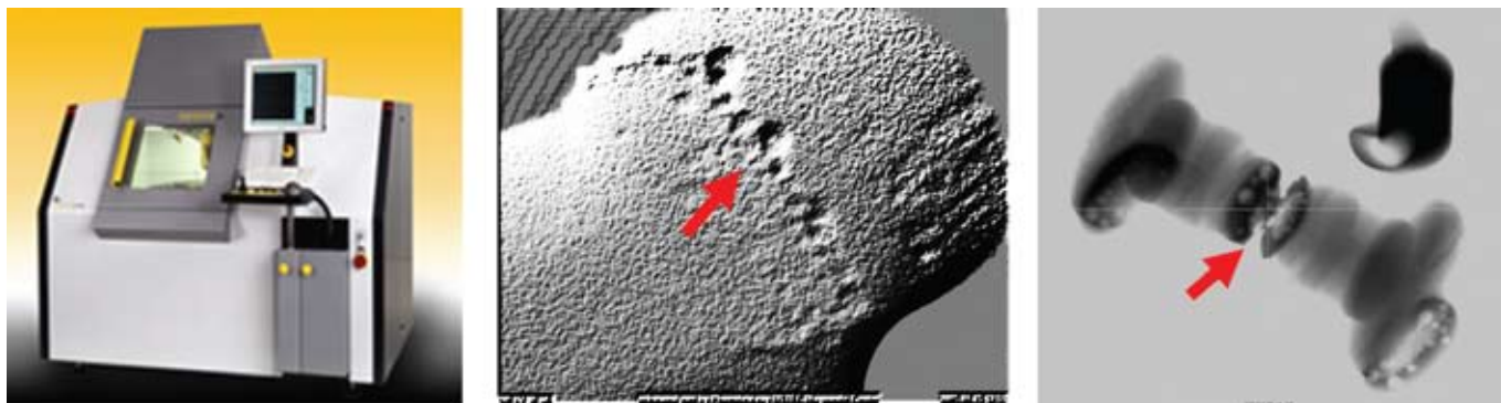
Рис. 5 Системы рентгеновской инспекции (слева) в настоящий момент являются одним из наиболее эффективных средств контроля качества паяных соединений (в центре) и внутреннего состояния электронных компонентов (справа)
