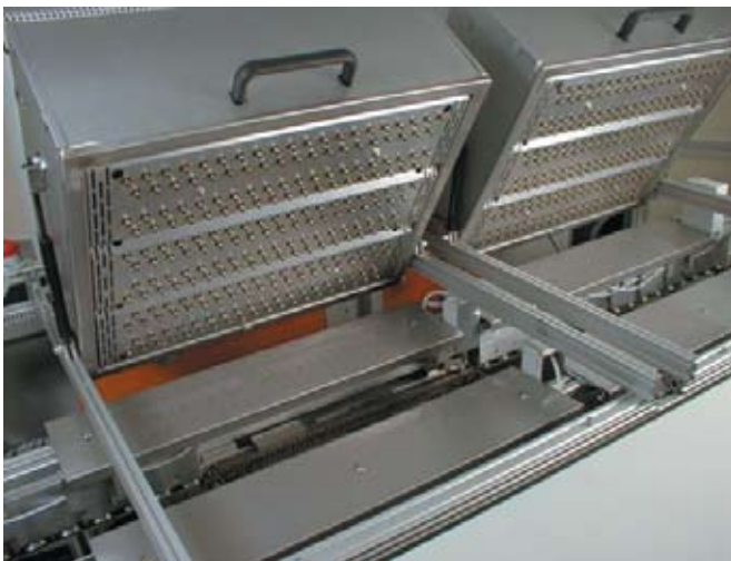
Рис. 7 Патентованная система предварительного нагрева снизу и сверху конвекционными модулями Multijet обеспечивает равномерный нагрев печатных узлов, не допуская перегрева термочувствительных компонентов. Рекомендуется для флюсов с низким содержанием летучих органических соединений (VOC free)
